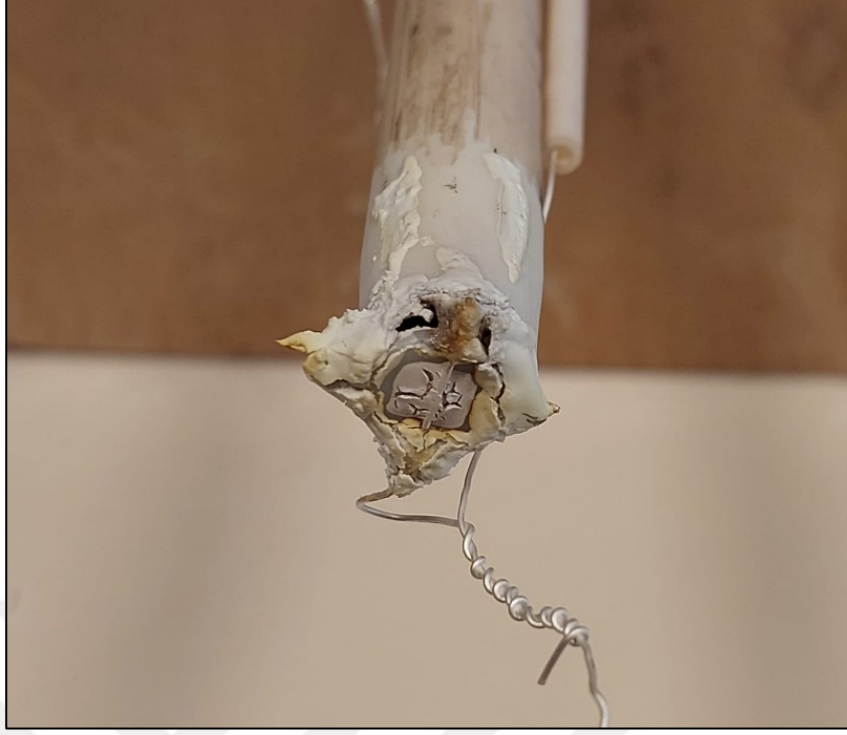
Şekil 5.20: Sızdırmazlık testi sırasında çatlayan numunenin görüntüsü.
