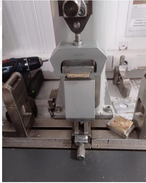
Şekil 3.6: Yüzeye dik çekme analizi
