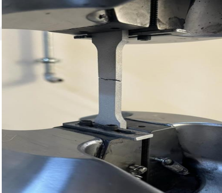
Şekil 4.3: Çekme Testi İçin Kullanılan Cihaz Ve Numune Görüntüsü.
