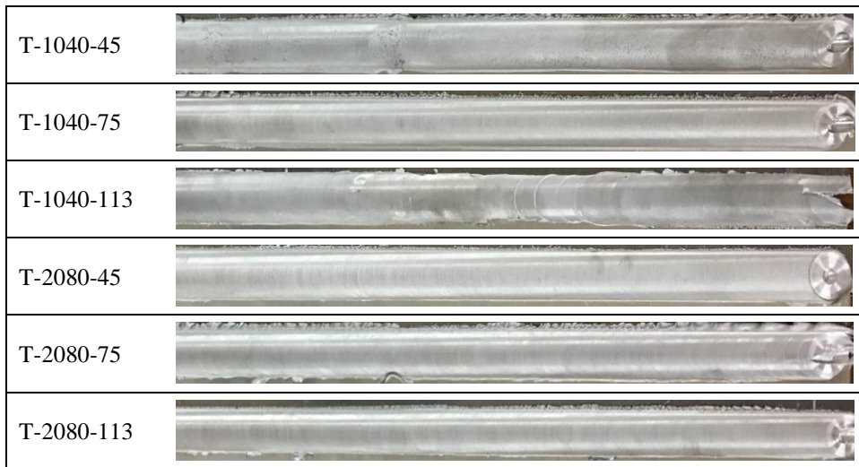
Şekil 4.1. SKK'li Numunelerin Kaynak Yüzey Görüntüleri
