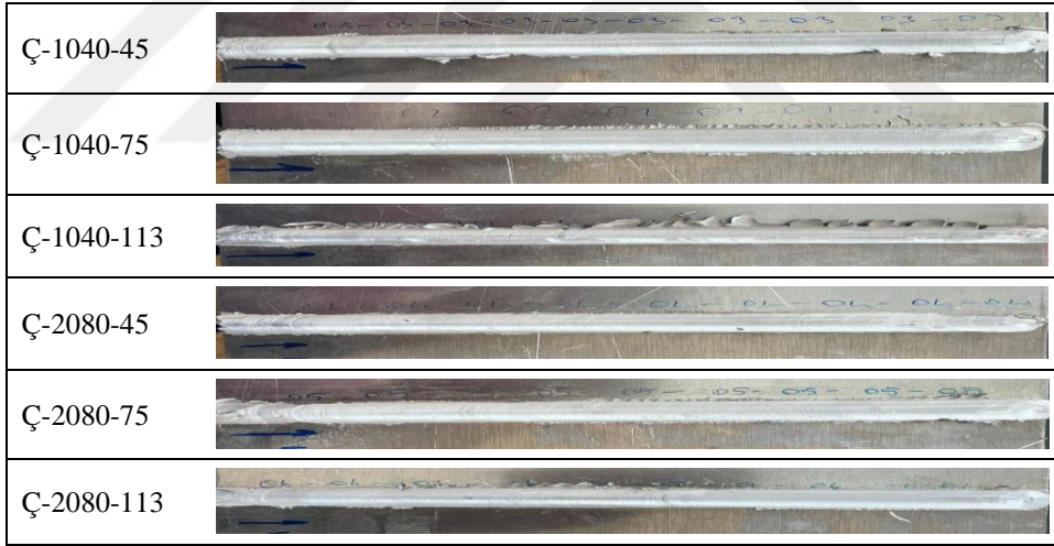
Şekil 4.3. ÇT-SKK'li Numunelerin Kaynak Yüzey Görüntüleri
