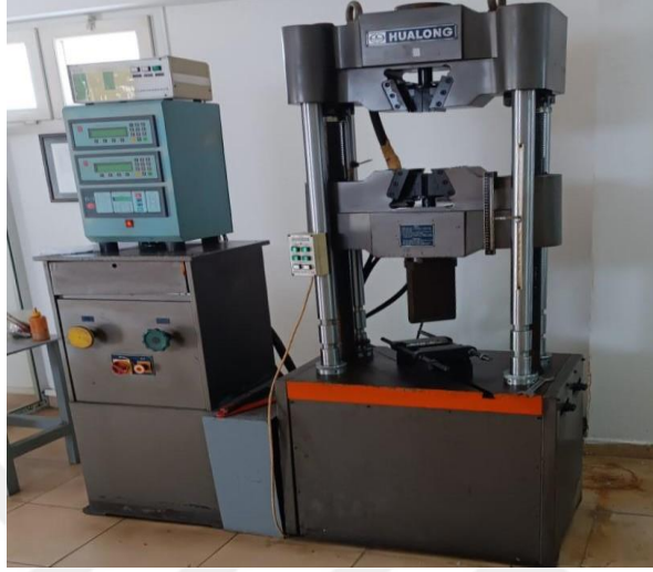
Şekil 3.8. Eğme Deneyi Makinesi
