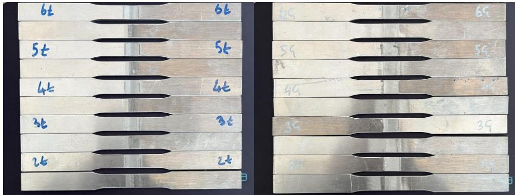
Şekil 3.12. Çekme Deneyi Numuneleri
