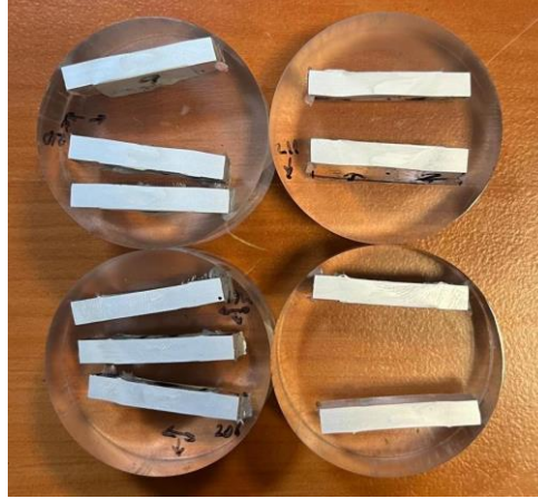
Şekil 3.14. Işık Mikroskobu İncelemeleri ve Mikro-Sertlik Ölçüm Numuneleri
