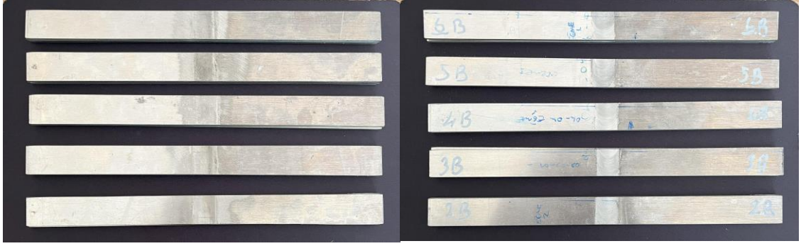
Şekil 3.13. Eğme Deneyi Numuneleri
