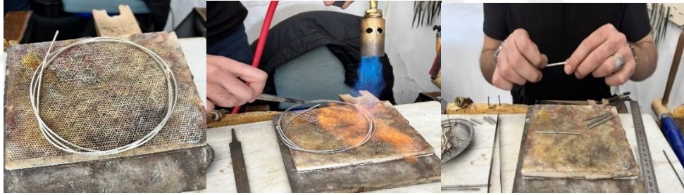
Resim 4.98. İskelet telinin tavllanması ve kesilmesi
