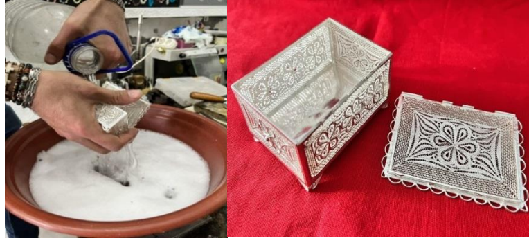
Resim 4.171. Bilye ile parlatma işleminden sonra ürünlerin son kez yıkanması
