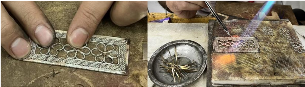
Resim 4.107. Uzun kenarlı çerçeve motiflerinin yerleştirilmesi
