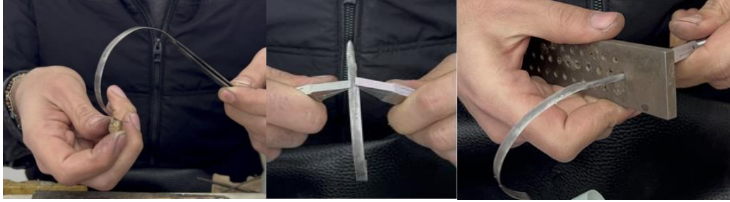
Resim 4.149. Gümüş plakanın boru şekline dönüştürülmesi
