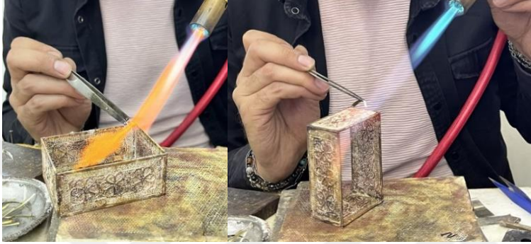
Resim 4.121. Büyük parçalarda büyük şalimo başlığının kullanılması
