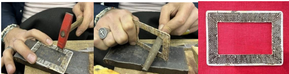
Resim 4.140. Kapak çerçevesinin çekiçle düzeltilmesi ve eğeyle pürüzlerinin giderilmesi
