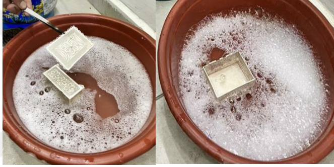
Resim 4.165. Zaç yağından çıkarılan ürünlerin deterjanlı suya konulması
