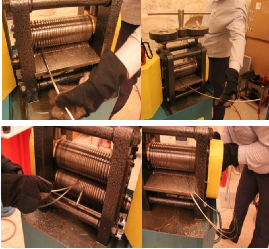
Resim 4.88. Çubuk gümüşün silindir makinesinden geçirilmesi
