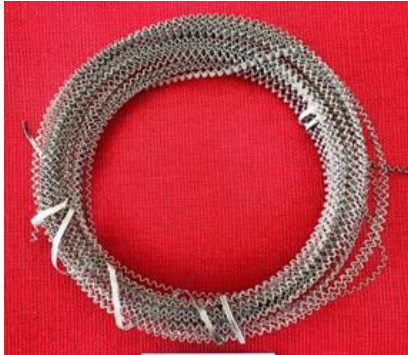
Resim 4.109. 65 Mikron iç dolgu zikkak tel Resim 4.110. 65 Mikron iç dolgu düz tel
