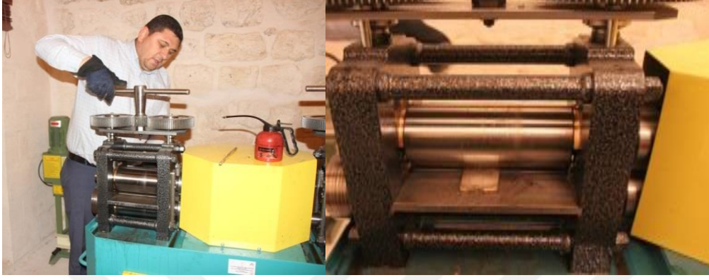
Resim 4.95. Silindir makinesinde gümüşü plaka haline getirme
