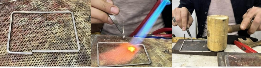
Resim 4.133. Kapak iskeletinin birleştirilmesi
