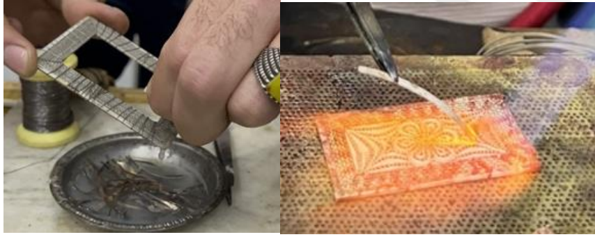
Resim 4.119. Boraks sürülmesi ve kaynak yapılması
