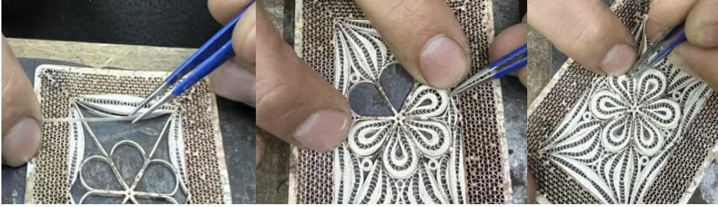
Resim 4.145. Kapakta papatya etrafına ve yapraklarına iç dolgu süslemelerin işlenmesi
