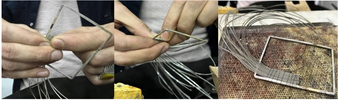
Resim 4.136. Düz ve zikzaklı tellerin dizilmesi ve çelik telle bağlanması
