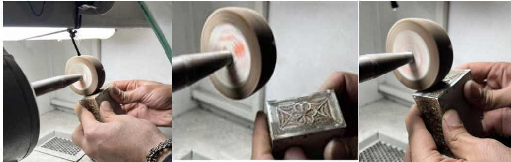
Resim 4.125. Zemin plakasıyla birleştirilen kutunun zımpara makinesinden geçirilmesi
