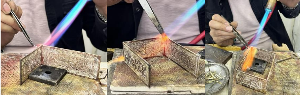
Resim 4.120. Kısa ve uzun çerçevelerin birleştirilmesi
