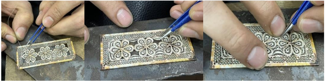
Resim 4.115. Boşluklara iç dolguların işlenmesi
