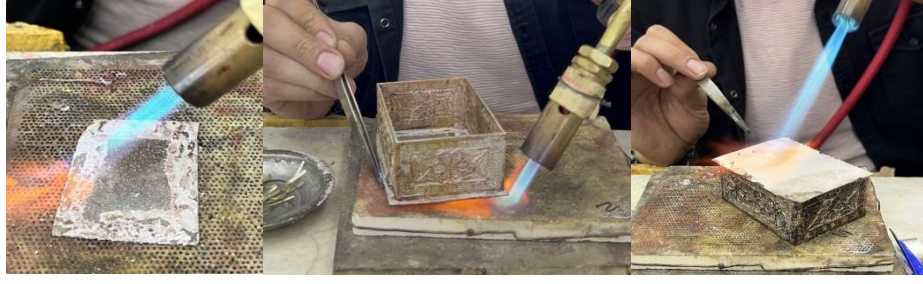
Resim 4.123. Zemin plakasının kutu çerçevesine (gövde) kaynakla birleştirilmesi
