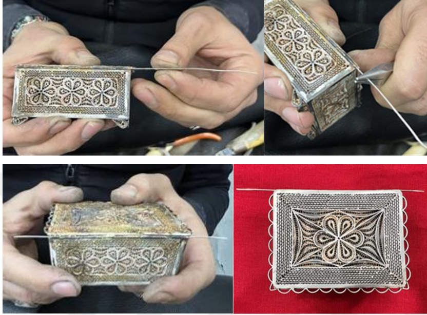
Resim 4.160. Menteşe iğnesinin menteşeye geçici olarak yerleştirilmesi
