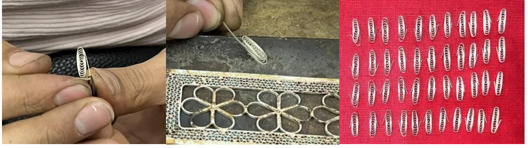
Resim 4.113. Çift yardımıyla iç dolgu tellerinin sarılması
