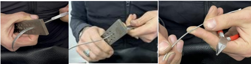
Resim 4.150. Şarnelin haddelerden geçirilerek inceltilmesi
