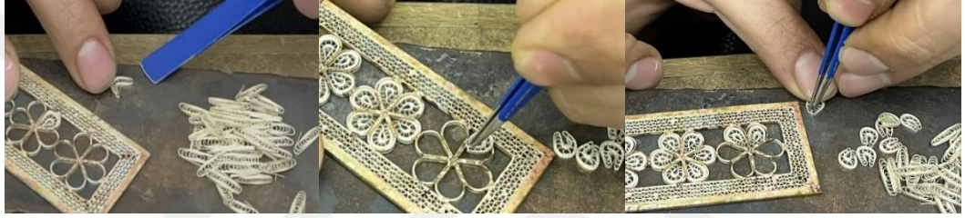
Resim 4.114. Papatya yapraklarına iç dolguların işlenmesi
