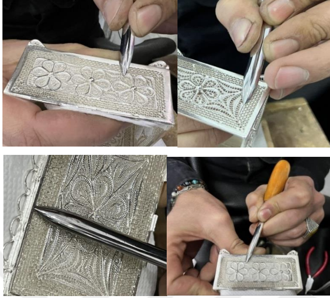
Resim 4.169. Büyük parçaların maskala ile parlatılması
