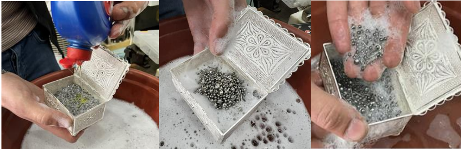
Resim 4.170. Kutunun iç kısmının bilyelerle parlatılması
