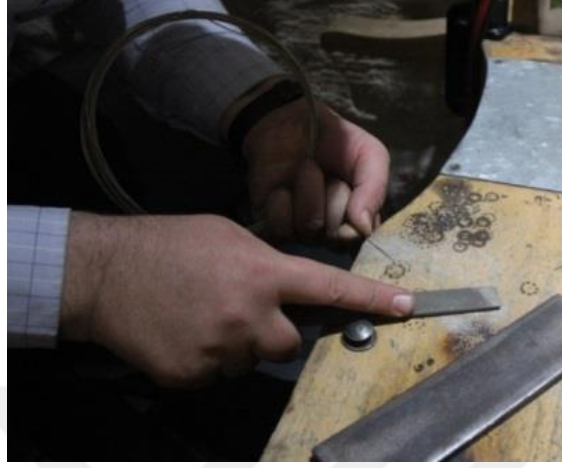
Resim 4.90. Telin ucunun eğe ile düzeltilmesi
