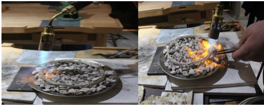
Resim 4.91. Halka telin mucur taşlar üzerinde tavllanması
