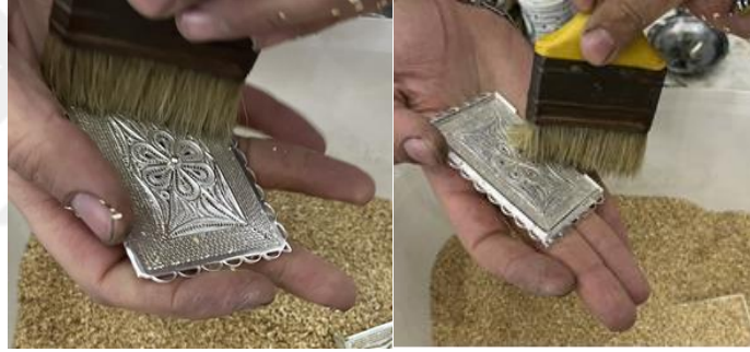
Resim 4.168. Ürünün talaş parçalarından temizlenmesi
