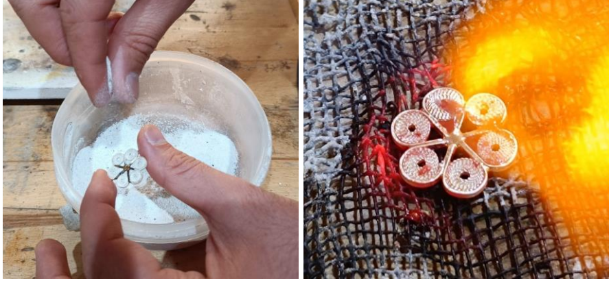
Resim 4.118. Toz kaynağın ürüne serpilmesi ve şalimoyla kaynak yapılması
