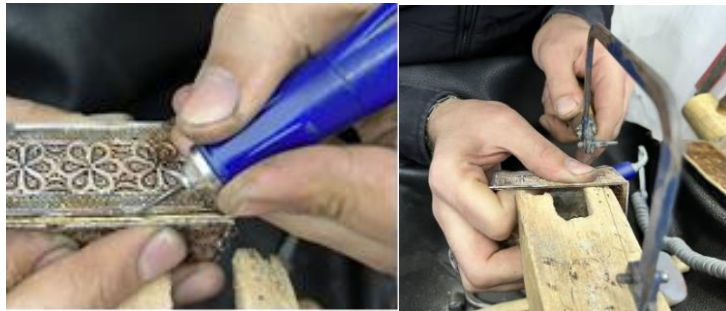
Resim 4.156. Şarnelin işaretli kısımlarının kıl testere ile kesilmesi
