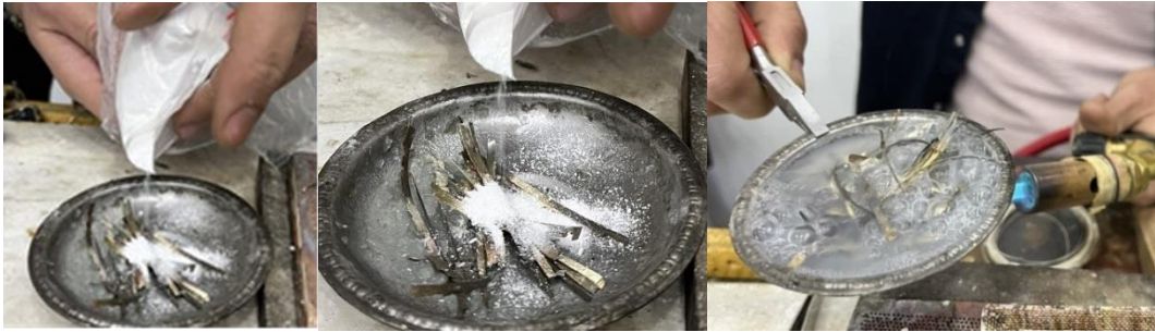
Resim 4.117. Çubuk kaynağa boraks ilave edilmesi ve sulandırılması Toz kaynak
