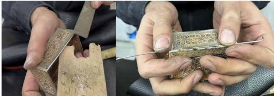
Resim 4.153. Şarnel takılacak kutu ağzının eğelenmesi ve ölçüsünün alınması
