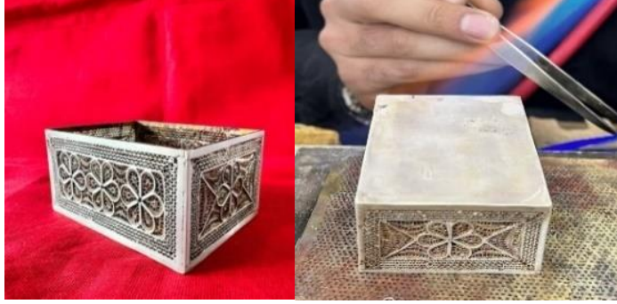
Resim 4.126. Mücevher kutusu taban plakasının tavlama işlemi
