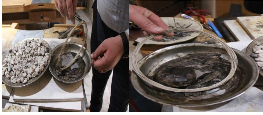
Resim 4.92. Halka tele balmumunun sürülmesi
