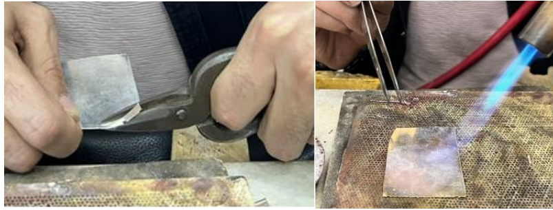
Resim 4.122. Gümüş plakanın kesilmesi ve tavllanması
