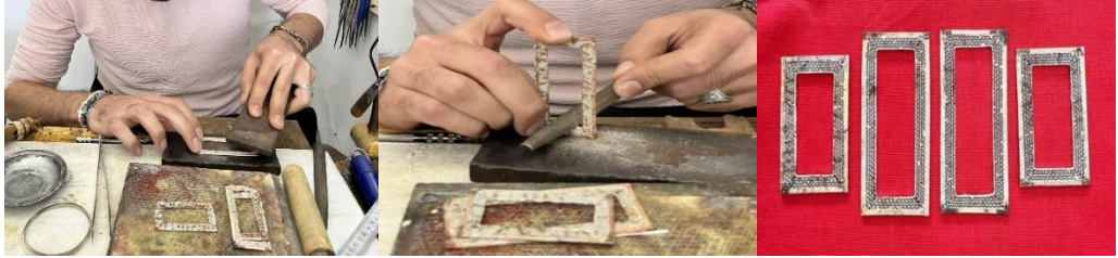
Resim 4.103. Çerçevelerin eğe ve örsle düzeltilmesi
