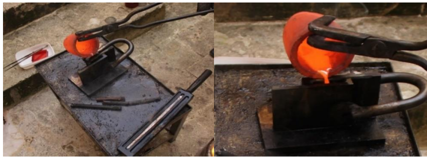
Resim 4.85. Potadaki gümüşün plaka şidesine dökülmesi
