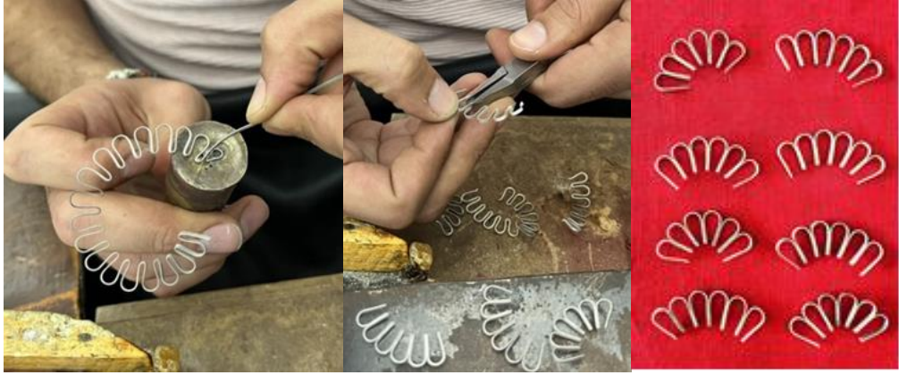
Resim 4.104. Papatya çiçeği iskeletinin el kalıbıyla hazırlanması
