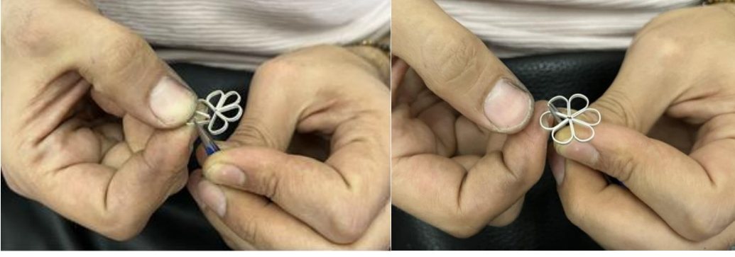
Resim 4.105. Papatya çiçeği iskeletinin şekillendirilmesi
