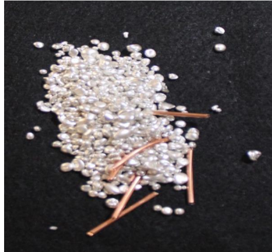
Resim 3.1. Gümüş ve bakırın eritilmeden önceki karışımı
