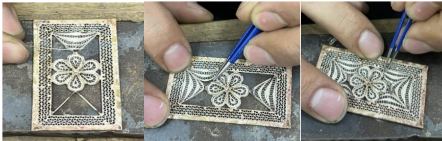
Resim 4.116. Kısa çerçeve boşluklarına iç dolguların işlenmesi
