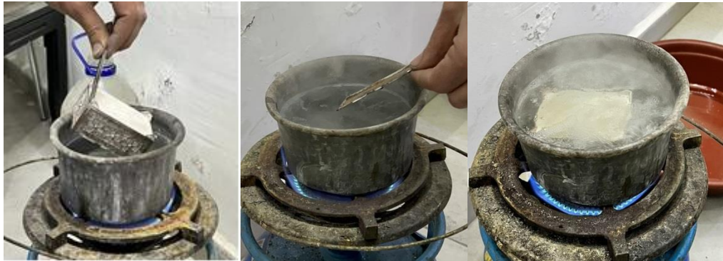
Resim 4.163. Kutu parçalarının asitli suya konulması
