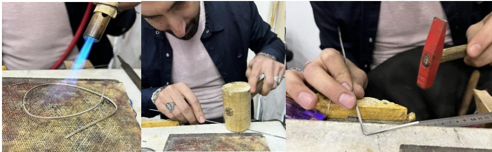
Resim 4.131. Kapak iskelet telinin hazırlanması
