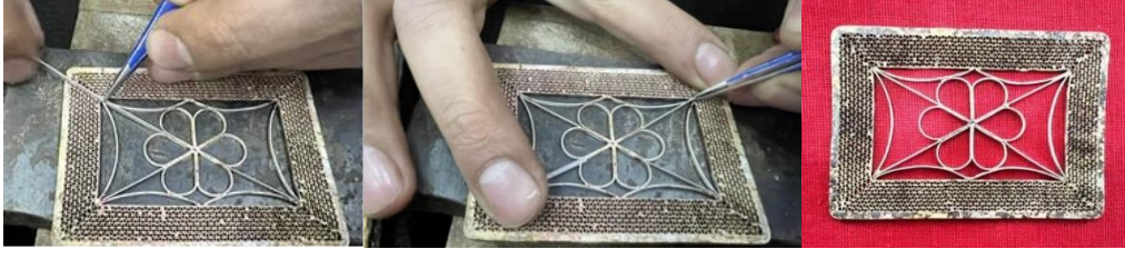
Resim 4.144. Kapağa iskelet telinden desen yapılması
