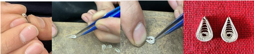
Resim 4.128. Damla motifli ayakların iç dolgularının hazırlanması
