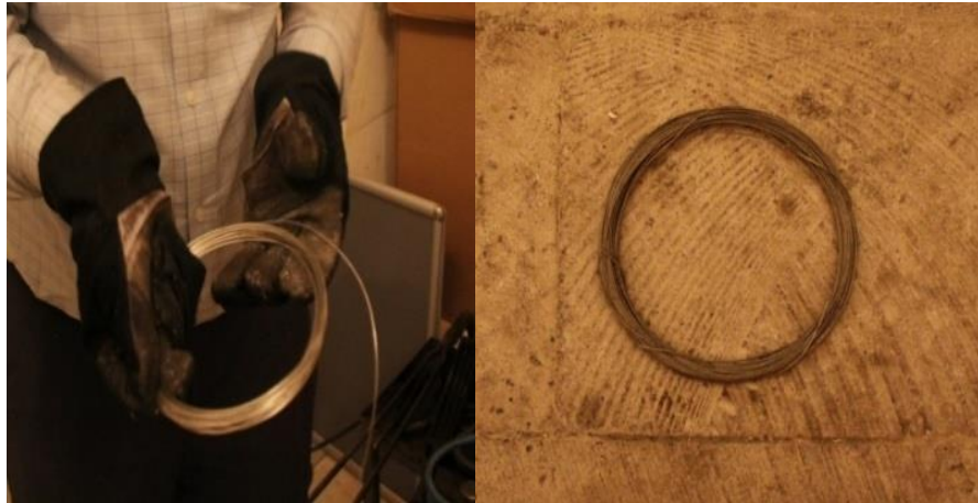
Resim 4.89. Uzayan ve inceltlen telin halka biçiminde sarılması
