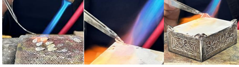
Resim 4.129. Ayak parçalarının kutunun zeminine birleştirilmesi
