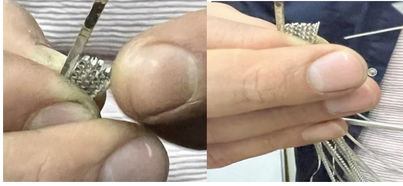
Resim 4.135. Düz ve zikzaklı tellerin birleştirilmesi
