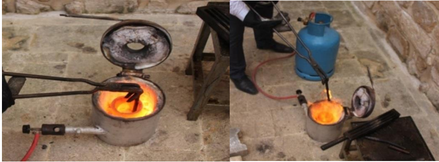
Resim 4.83. Erimeye başlayan gümüş ve bakırın karıştırılması
