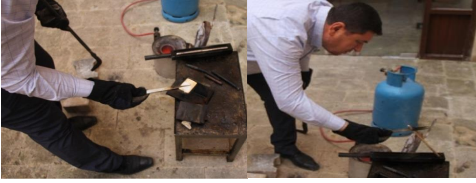
Resim 4.86. Plaka ve çubuk gümüşün şidelerden çıkarılması
