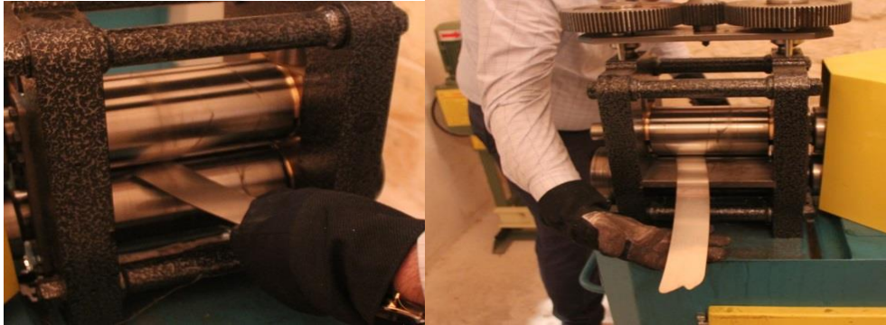
Resim 4.96. Silindir makinesinde plaka çekme
