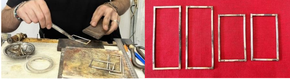
Resim 4.100. Uzun ve kısa çerçeve tellerinin hazırlanması
