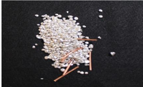
Resim 4.81. Gümüşe bakır eklenmesi
