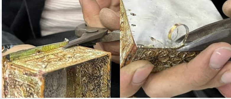
Resim 4.124. Fazlalıkların makasla kesilmesi
