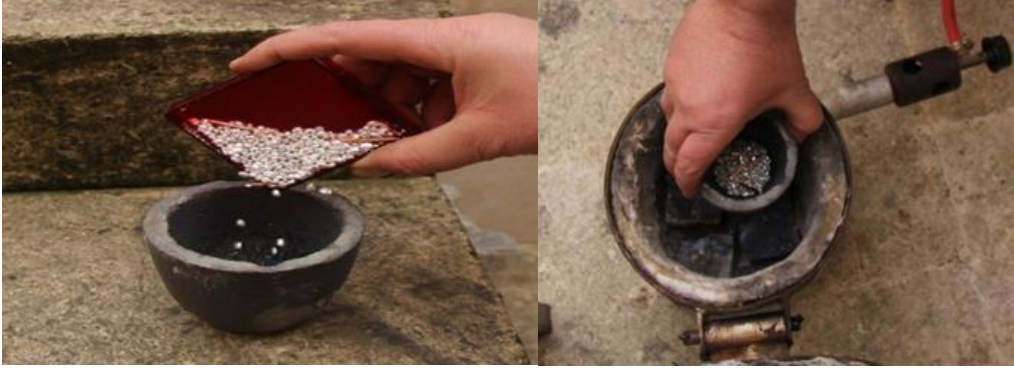
Resim 4.82. Potanın tüplü eritme ocağına yerleştirilmesi
