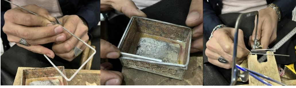
Resim 4.132. Kapak iskeletinin ölçüsünün alınması ve kıl testere ile kesilmesi
