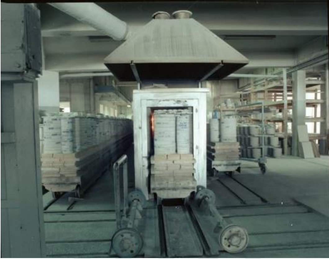
Şekil 4.20 Fabrika'nın II. dönemine ait (1986-Sümerbank dönemi) tünel fırını [41]
