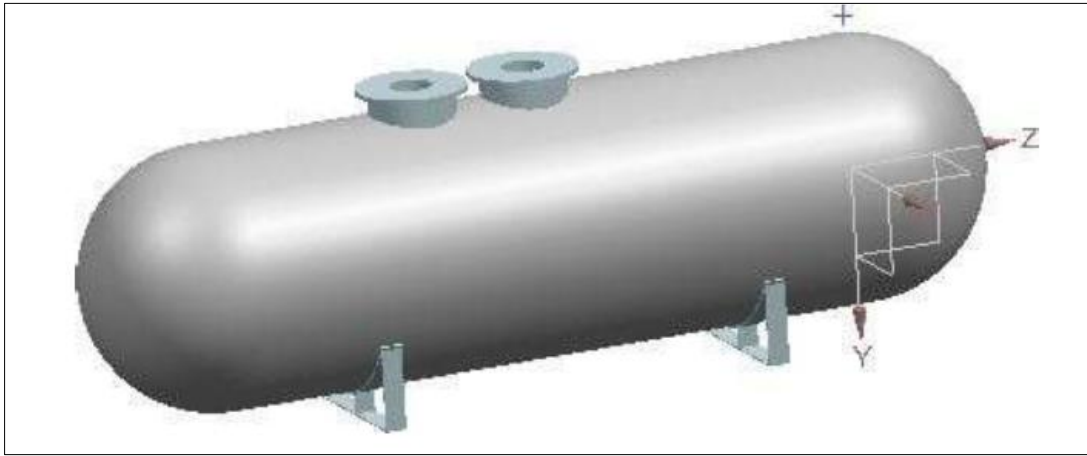
Şekil 2.6. İki nozul deliği ile oluşturulmuş 3B tasarım modeli [27].
