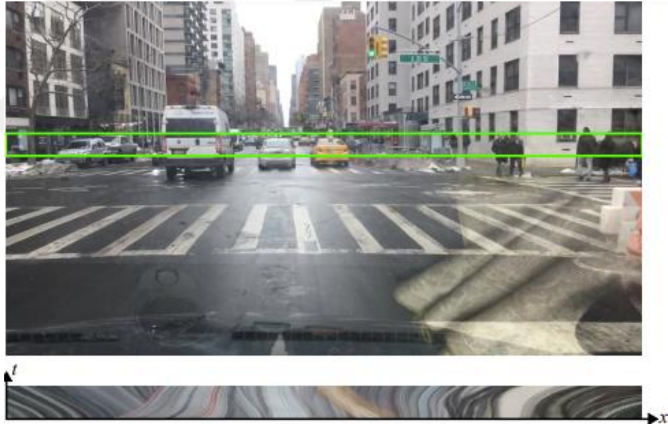
Şekil 1.1. Yeşil bantla oluşturulan MPI, üstteki mevcut kareyi ve alttaki 1 saniye öncesini gösterir.
