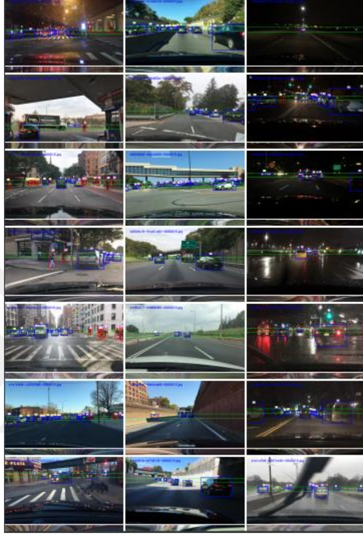
Şekil 5.4. Sürüş senaryolarında Two-Stream[M] modeli kullanılarak nesne ve hareket algılama sonuçları
