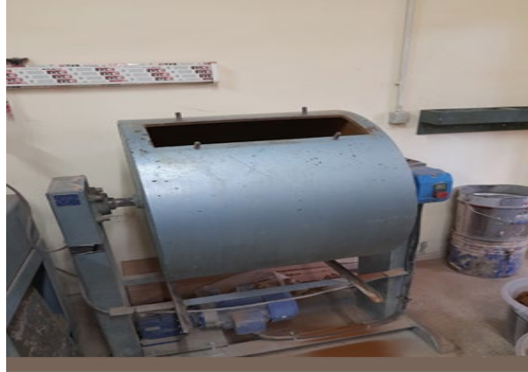
Şekil 6.3 Yıldız Teknik Üniversitesi İnşaat Fakültesi yapı malzemeleri laboratuvarında bulunan ve kurutulan çamurların küçük parçalar haline getirildiği Los Angeles deney aleti
