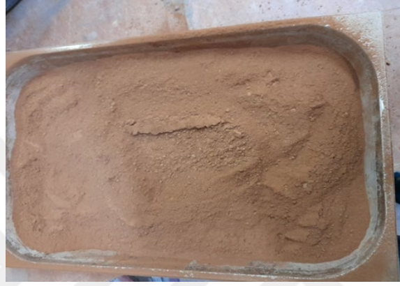
Şekil 6.9 Öğütülerek filler malzeme haline getirilmiş İSKİ Cumhuriyet arıtma tesisi çamuru
