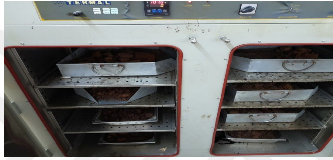
Şekil 6.2 Çamurların Yıldız Teknik Üniversitesi İnşaat Fakültesi yol ve bitüm laboratuvarında kurutulduğu etüve yerleştirilme biçimi
