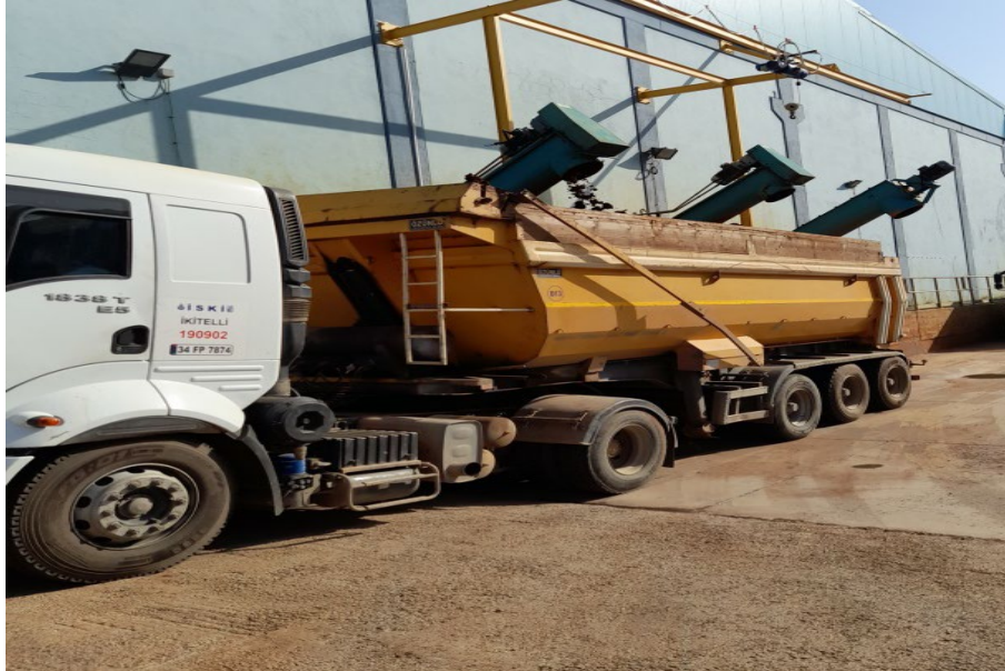
Şekil 5.19 Susuzlaştırılan çamurun depolara götürülmek üzere kamyonlara yüklenmesi [73]
