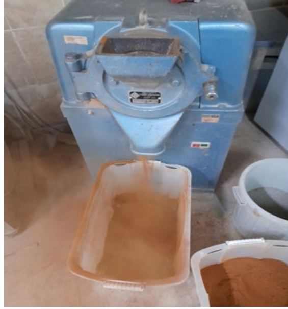
Şekil 6.4 Yıldız Teknik Üniversitesi İnşaat Fakültesi yapı malzemeleri laboratuvarında bulunan ve küçük parçalar halindeki çamuru filler malzemeye dönüştüren öğütme makinası
