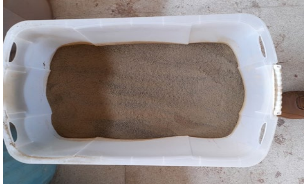
Şekil 6.14 Öğütücüden geçirilerek filler malzeme haline getirilen İSKİ İkitelli içme suyu arıtma çamuru
