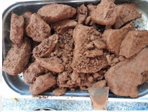
Şekil 6.6 İSKİ Cumhuriyet arıtma tesisinden elde edilen çamurun kurutulmadan önce numune kabındaki görüntüsü
