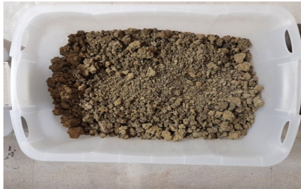
Şekil 6.13 İSKİ ikitelli içme suyu arıtma çamurunun Los Angeles aşınma kabında küçük parçalara bölünmüş görüntüsü
