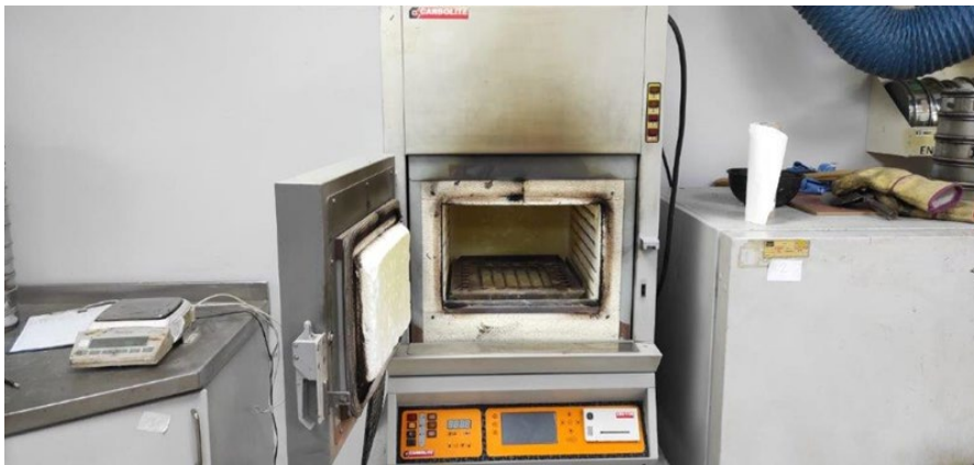
Şekil 6.5 Kurutulan çamurun içinde bulunan organik maddeleri bertaraf etmek için kullanılan fırın
