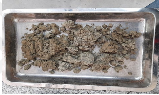
Şekil 6.12 İSKİ ikitelli içme suyu arıtma çamurunun kurutulduktan sonra numune kabındaki görüntüsü
