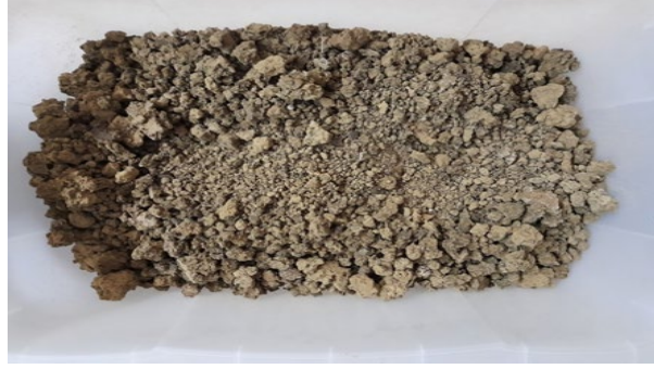
Şekil 6.11 İSKİ ikitelli içme suyu arıtma çamurunun kurutulmadan önce numune kabındaki görüntüsü
