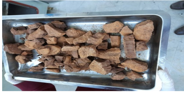
Şekil 6.7 İSKİ Cumhuriyet arıtma tesisinden elde edilen çamurun kurutulduktan sonra numune kabındaki görüntüsü
