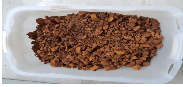
Şekil 6.8 Los Angeles deney aletinde küçük parçacıklar haline getirilmiş İSKİ Cumhuriyet arıtma tesisi çamuru
