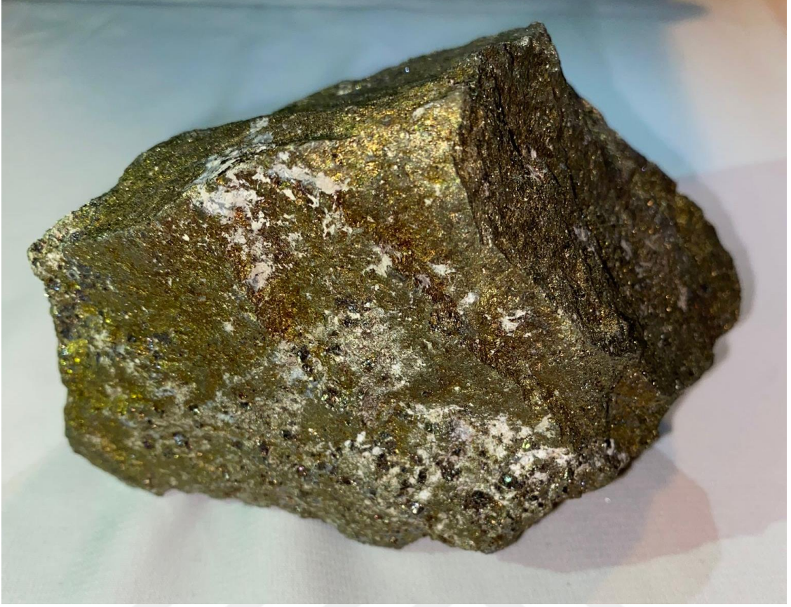
Fotoğraf 13: Pirit (açık sarı), kalkopirit (koyu sarımsı), kuvars (gri) cevheri örneği
