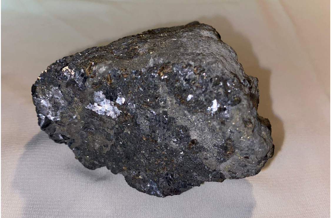
Fotoğraf 11: Galen ve sfalerit (ZnS) cevher örneği
