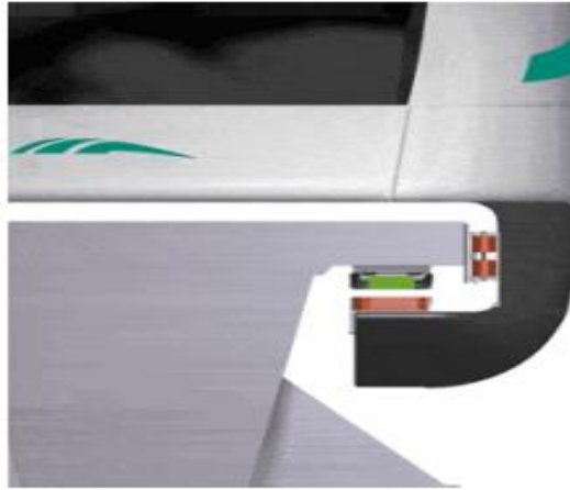
Şekil 2.4 : EMS sisteminde yanal kılavuzluk ilkesi [8].
