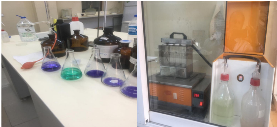
Şekil 12. Protein analizi ve yakma işlemi
