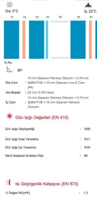
Şekil A.33 Cam-10 ile Cam-11/12/13'e ait ısısal ve görsel performans değerleri a:Cam-10, b: Cam-11/12/13
