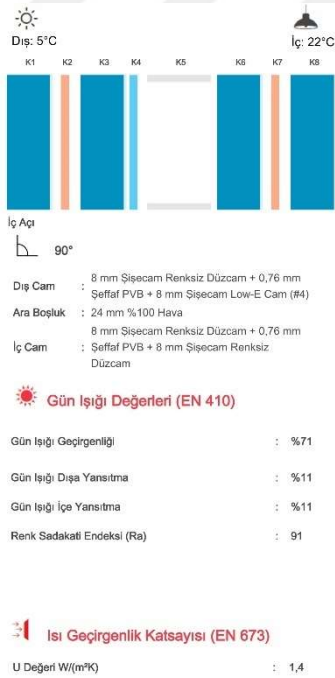
Şekil A.33 Cam-10 ile Cam-11/12/13'e ait ısısal ve görsel performans değerleri a:Cam-10, b: Cam-11/12/13
