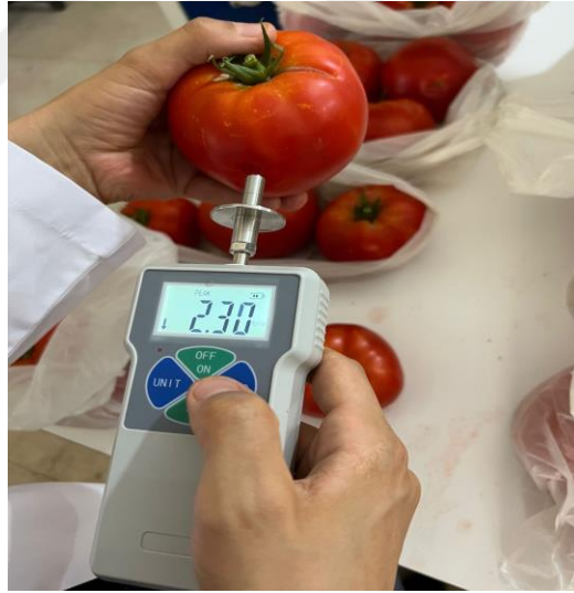
Şekil 12. Meyve sertliği ölçümü
