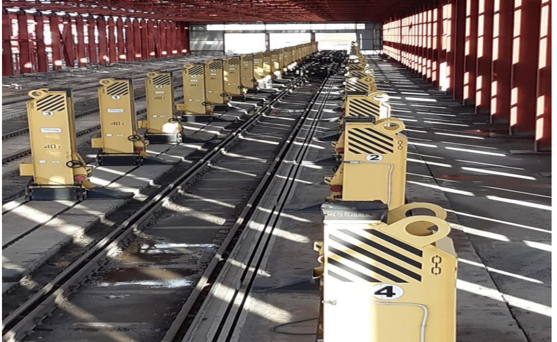
Şekil 1.3.2.3.1: Ahilkelek İstasyonu Boji Değişim İstasyonu
