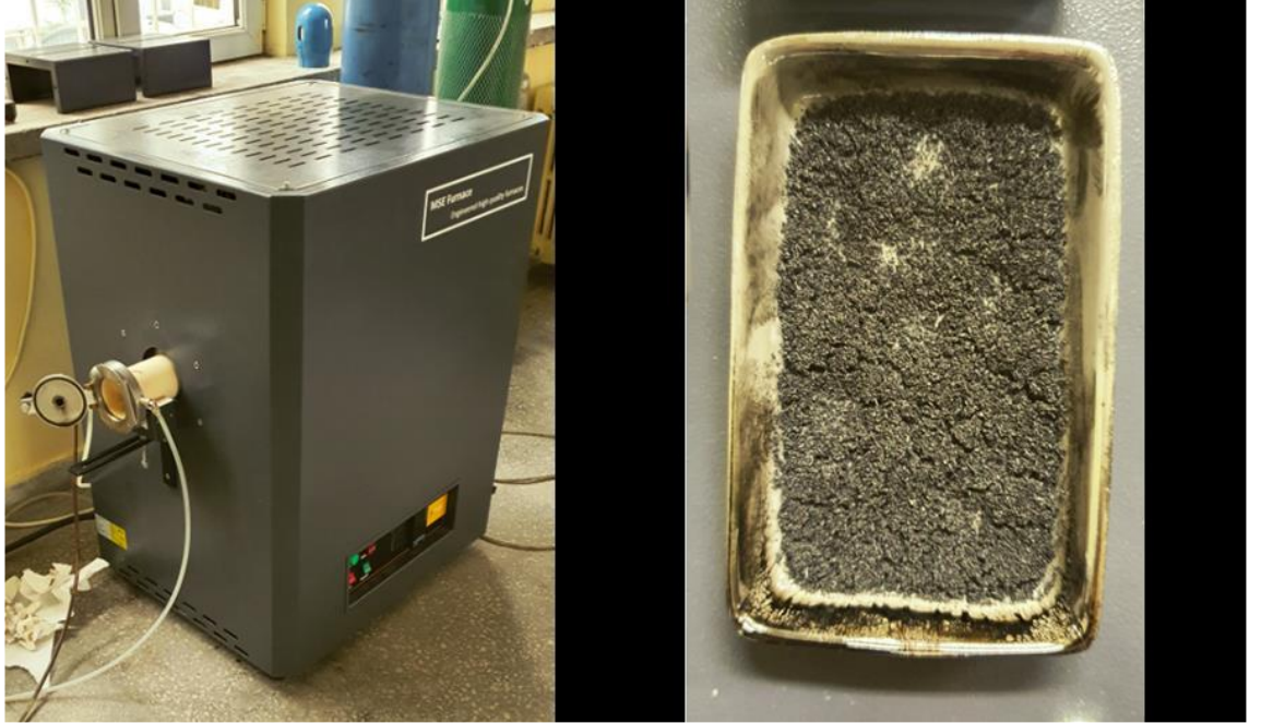
Şekil 2.5 Piroliz için kullanılan tüp fırın ve elde edilen biyokömür
