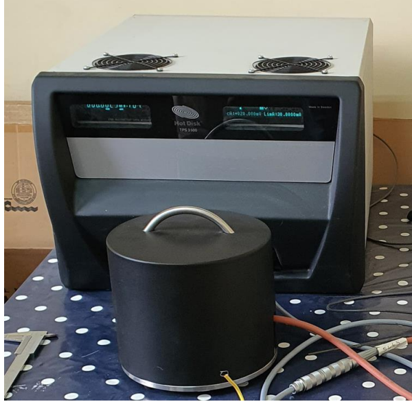
Şekil 2.14 Hotdisk TPS 3500 Termal iletkenlik ölçüm cihazı
