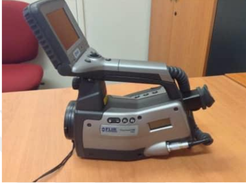
Şekil 2.28 Deneysel ölçümlerin gerçekleştirilmesinde kullanılan termal kamera
