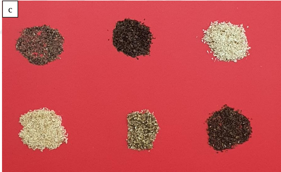
Şekil 2.4 RT-28 emdirilmiş organik malzemeler (a), RT-28 in gözenekli organik malzemeye emdirilmesi ve yüzeye yapışmış organik malzemedan arındırılması (b), RT-28 emdirilmiş ve sızdırmazlık testi gerçekleştirilmiş organik malzemeler (c).
