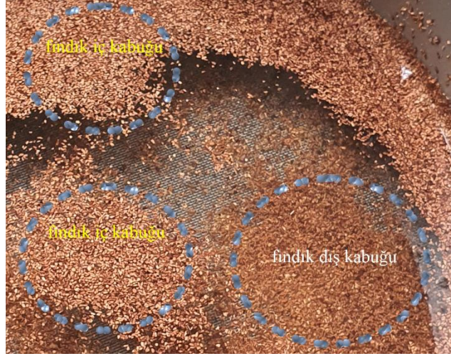
Şekil 2.2 Fındık iç kabuğu ve fındık dış kabuğunun yoğunluk farkından kaynaklı ayrıştırılma işlemi
