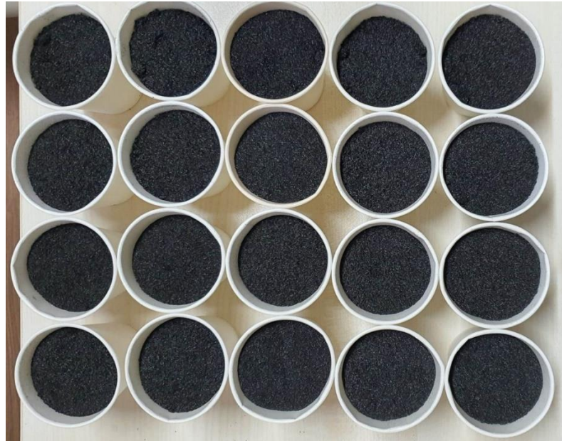
Şekil 3.8 300 °C maksimum sıcaklık, 10 °C ısıtma hızı ve 1 saat bekleme süresi ile üretilmiş biyokömürlere RT-28/ emdirilerek elde edilen biyokömür kompozitleri
