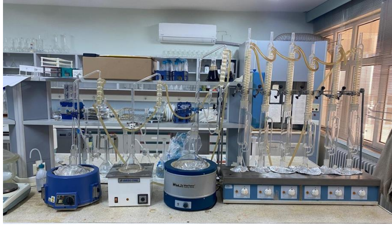
Şekil 3.7. Kullanılan Clevenger düzeneği
