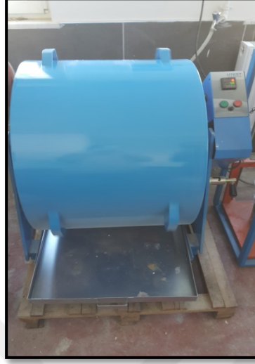
Şekil 3.11. LA aşınma aleti ve deney için hazır hale getirilmesi
