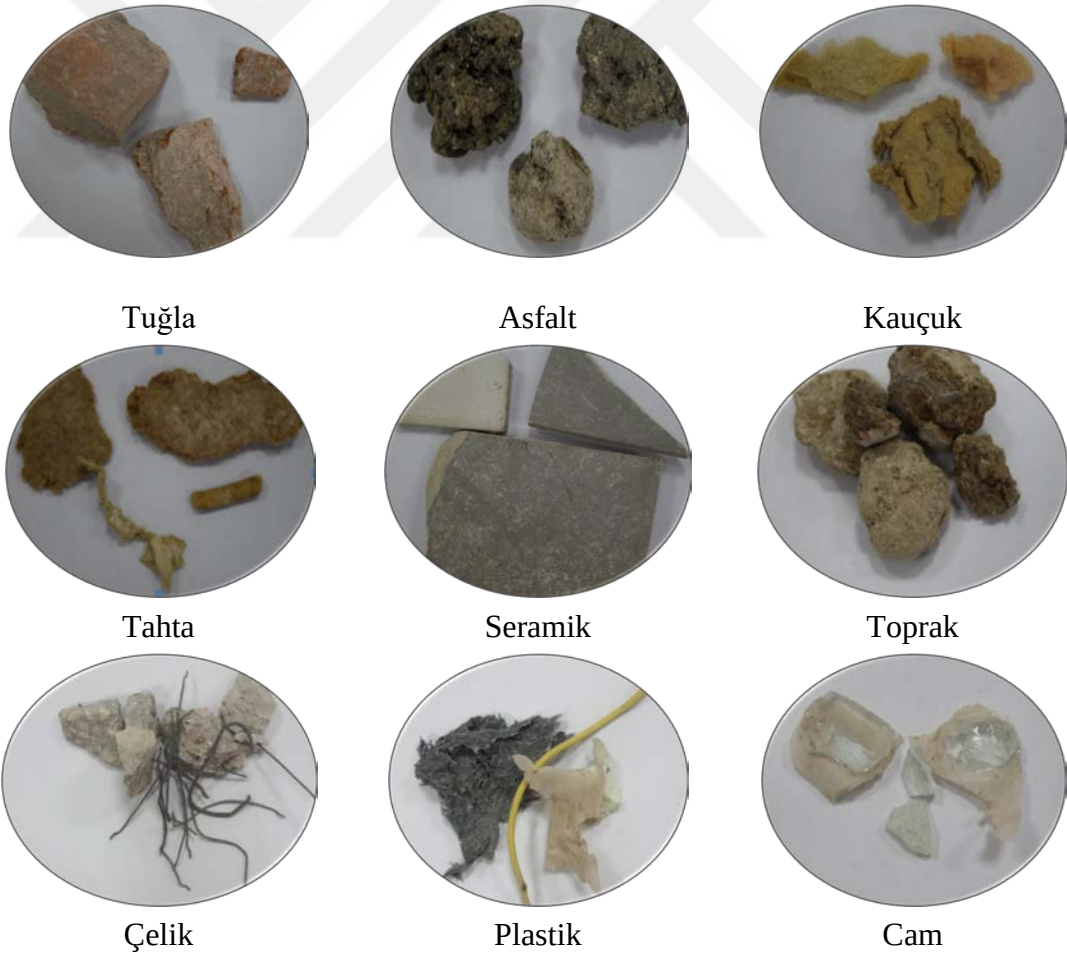
Şekil 2.9. Geri dönüştürülmüş beton agregası içerisinde bulunan safsızlıklar
