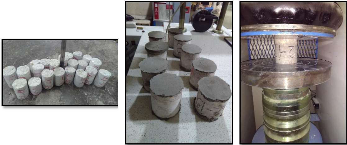
Şekil 3.2. Silindirik karot numuneleri ve basınç dayanımının belirlenmesi (PROTEST Yapı Araştırma ve Test Merkezi, 2019)
