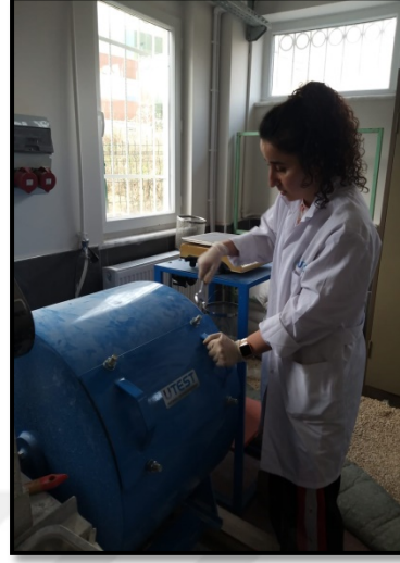
Şekil 3.11. LA aşınma aleti ve deney için hazır hale getirilmesi
