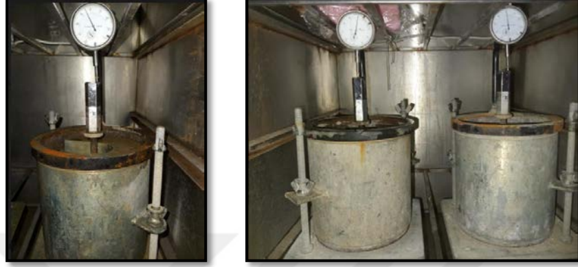
Şekil 3.19. Donma-Çözülme kabineye yerleştirilen 100GDBA karışımları
