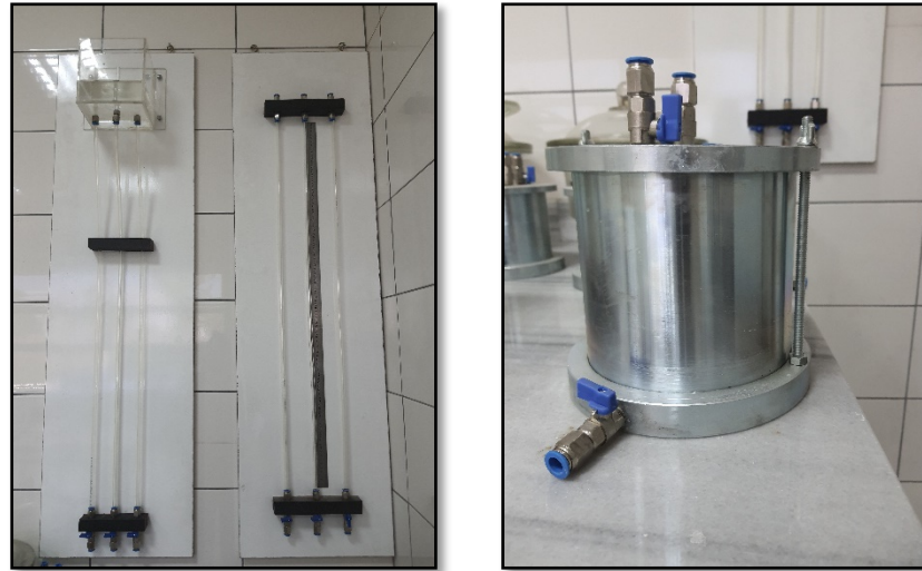
Şekil 3.21. Permeabilite deney düzeneği ve 100GDBA karışımı için hazırlanan numune örneği
