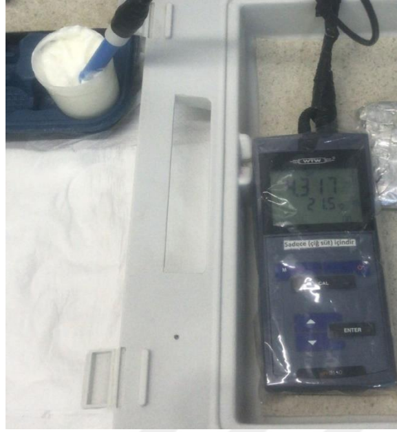
Şekil 3.4. Örneklerinin pH'larının pH metre (WTW, pH 3110, Weilheim, Almanya) ile belirlenmesi
