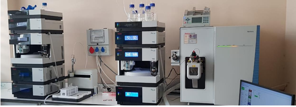
Şekil 3.8. Analizlerde kullanılan ultra performanslı sıvı kromatografisi-kütle spektroskopisi/ kütle spektroskopisi (UPLC-MS/MS) cihazı [Thermo Scientific Ultimate 3000 UPLC, Thermo Scientific- TSQ Fortis (Thermo Fisher Scientific Inc. Waltham, Massachusetts, ABD)]
