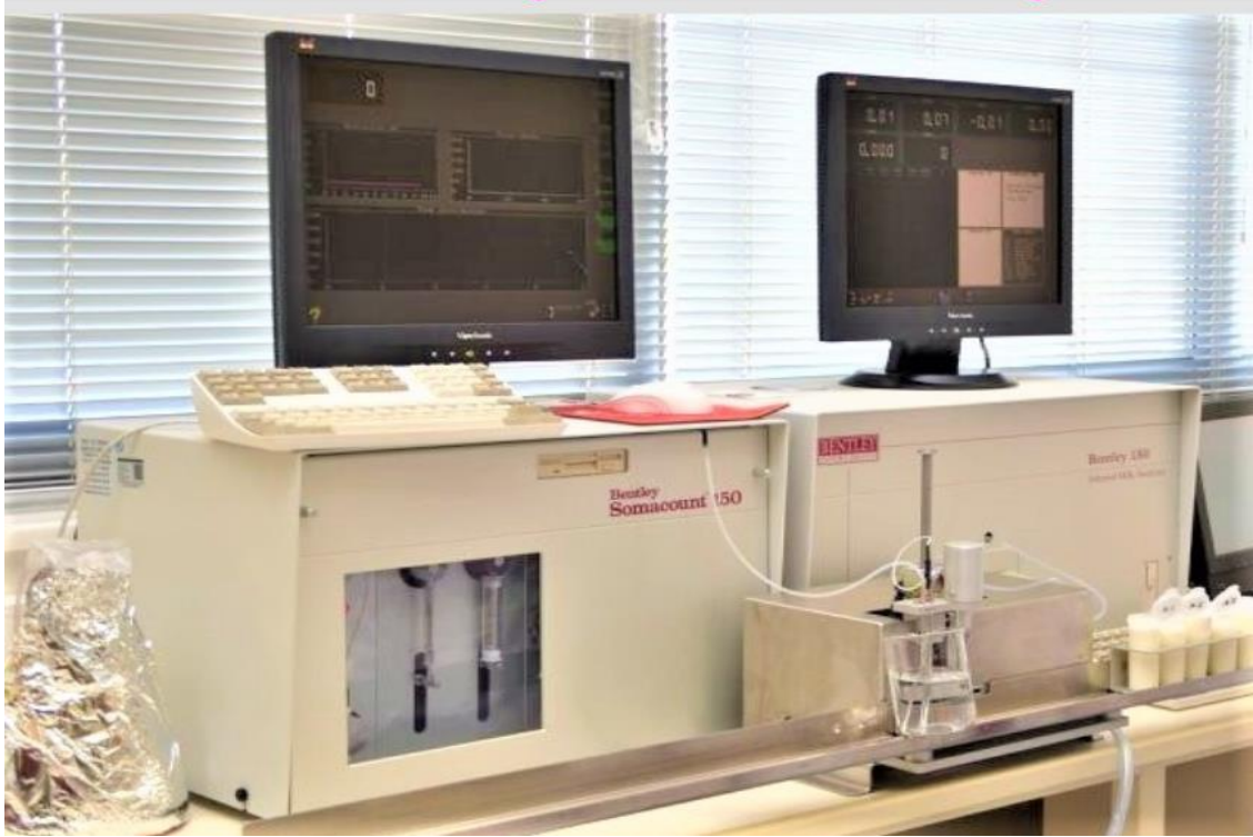
Şekil 3.2. Çiğ süt analizlerinde kullanılan Bentley Combi (B+S) 150 Süt Analiz Cihazı (Burdur Mehmet Akif Ersoy Üniversitesi Bilimsel ve Teknoloji Uygulama ve Araştırma Merkezi)
