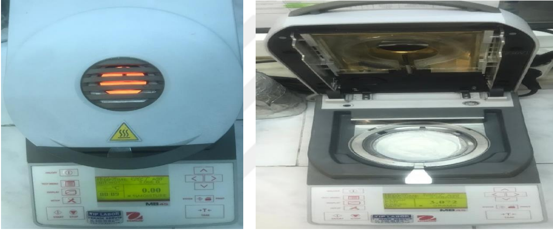
Şekil 3.3. Hızlı nem analizörü (MB45, Ohaus, Parsippany, NJ, ABD) ile % nem tayini
