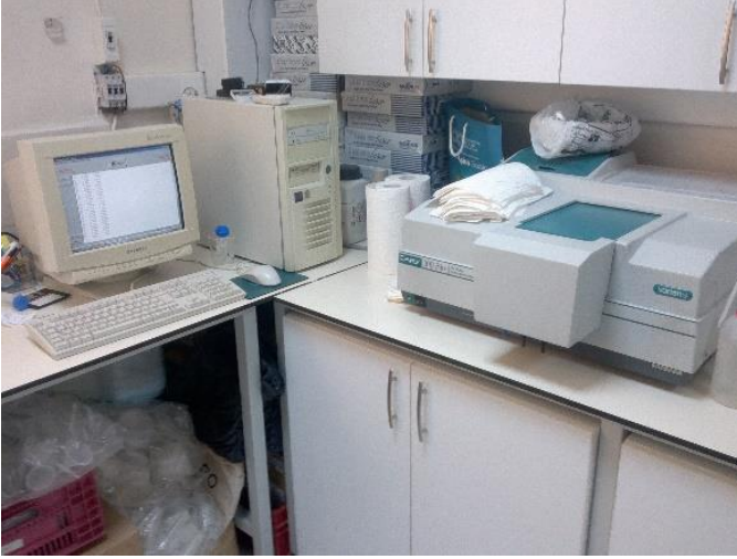
Şekil 3.5. Toplam fenol miktarı ve antioksidan aktivitesinin belirlenmesinde kullanılan spektrofotometre.
