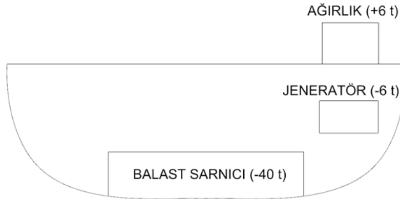
Şekil 3.1 Delta gemisine eklenen ve çıkan ağırlıklar (Kişisel arşiv, 2021)
