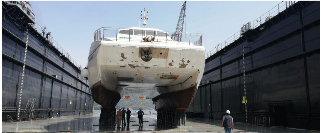
Şekil 1.3 Havuzlama işlemi tamamlanmış bir gemi (Kişisel arşiv, 2019)
