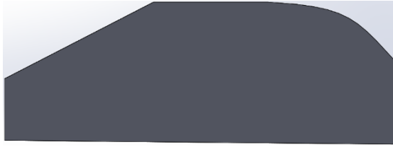
Şekil 4.18. Arka cam açısı 40° olan model
