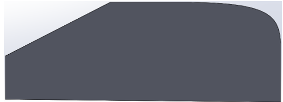
Şekil 4.21. Arka cam açısı 55° olan model
