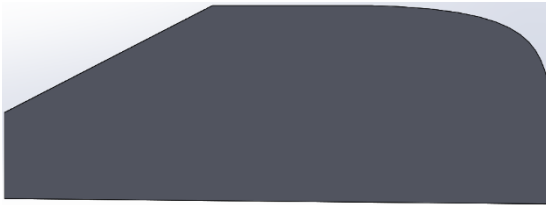
Şekil 4.20. Arka cam açısı 50° olan model
