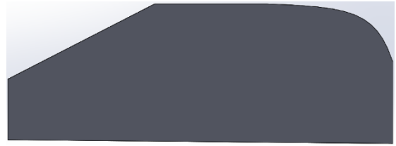
Şekil 4.19. Arka cam açısı 45° olan model
