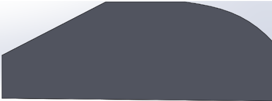
Şekil 4.16. Arka cam açısı 30° olan model
