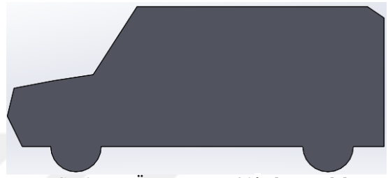
Şekil 4.3. Ön cam açısı 30^\circ olan model
