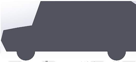
Şekil 4.2. Ön cam açısı 20^\circ olan model
