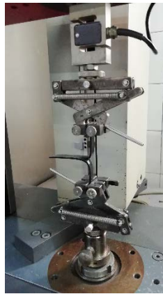
Şekil 3.18. Tensometre test cihazına bağlı pantolon yırtılma numunesi
