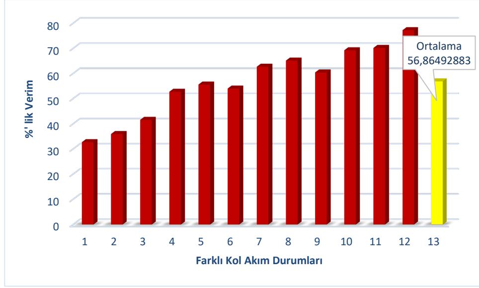
Şekil 34. 12 farklı akım kol durumları için uyarı yönteminin klasik yöntemle göre kavşak gecikme süresindeki verimi
