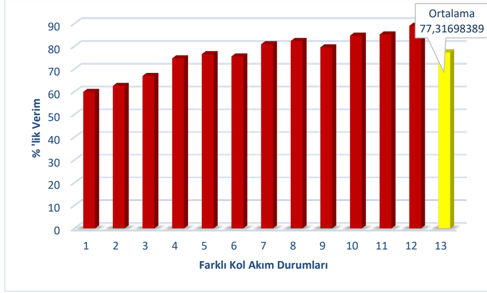
Şekil 37. 12 farklı akım kol durumları için uyarı yönteminin klasik yöntemle göre kavşak gecikme süresindeki verimi
