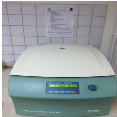
Şekil 3.6.. 15000 rpm’de 4°C’de 10 dakika santrifüj edilme (Hettich Universal 320R, Almanya) işlemi
