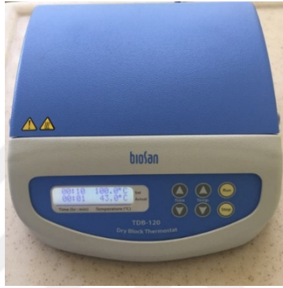
Şekil 3.5. 1-2 ml steril distile su içeren steril ependorf tüp içine alınarak örneklerin kuru blok ısıtıcı (Biosan Bio TDB-100, İstanbul-Türkiye) içinde 100°C’de 10 dakika inkübe edilme işlemi
