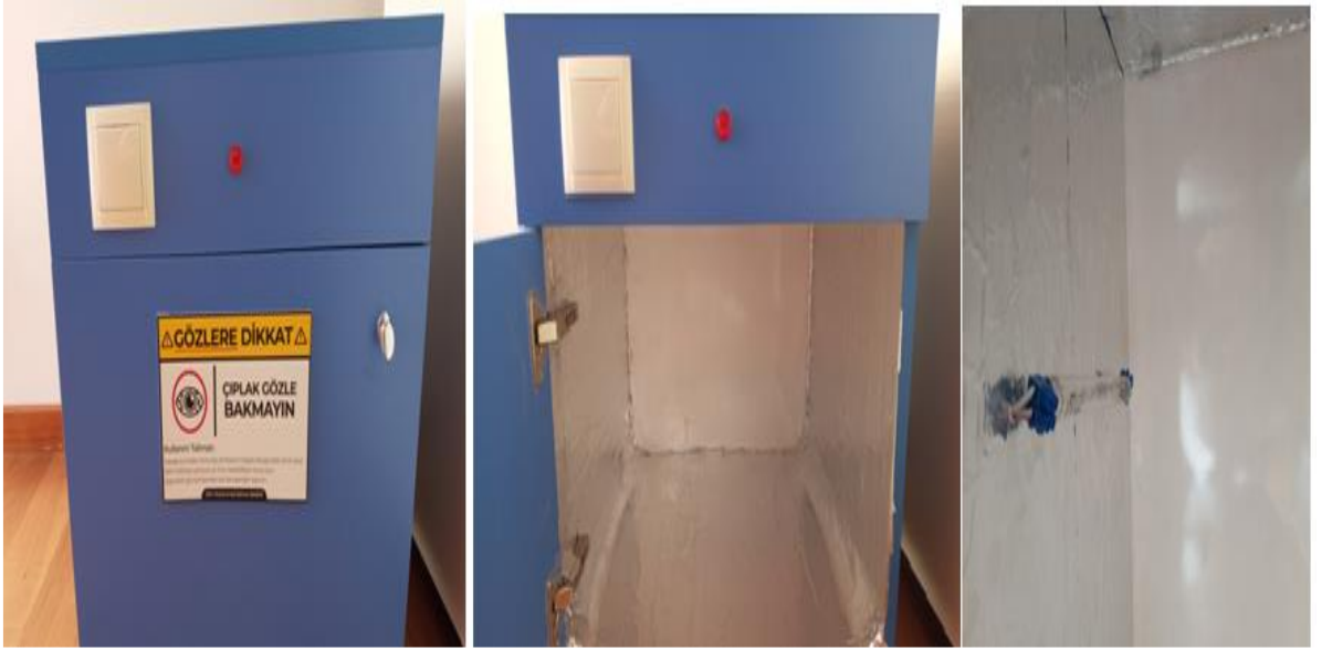
Resim 2: Philips-tuv-11w-g11-t5 UV-C kullanılarak geliştirilen içi alüminyum kaplı kutu
