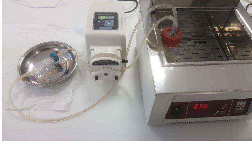
Şekil 3.5 TBS'nin GTMAC ile modifikasyonu.
