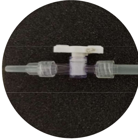
Şekil 3.15 Sitemde basınç kontrolünü sağlayabilmek için kullanılan vana.
