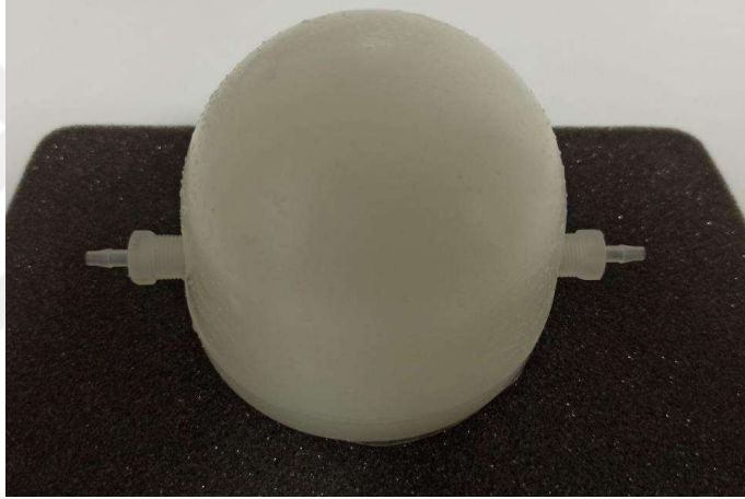
Şekil 3.14 Pulsatif akışı sabit akışa dönüştüren dampener (Masterflex Pulse Dampener, EW-07596-20, Cole Parmer, ABD).
