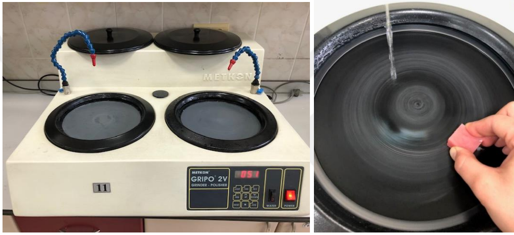
Şekil 7. Otomatik zımpara cihazı ve örneklerin zımparalanması
