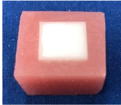
Şekil 6. Otopolimerizan akriliğe gömülmüş örnek
