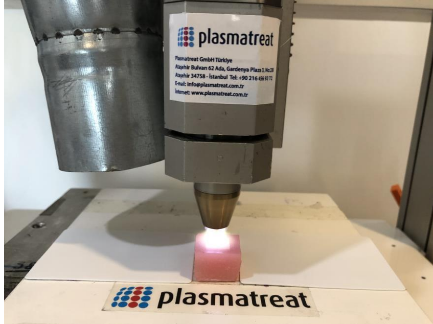
Şekil 12. Atmosferik basınçlı plazma uygulaması
