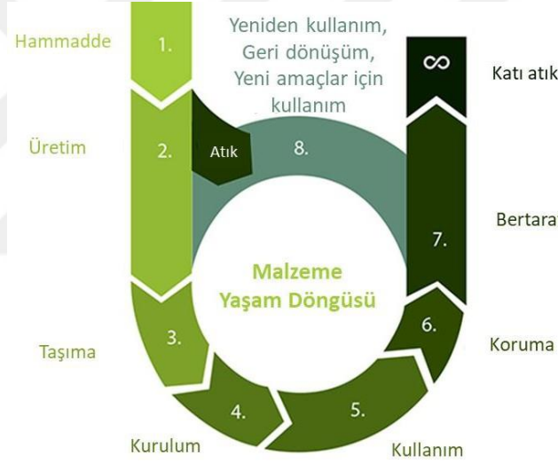
Şekil 4.4. Malzemelerin yaşam döngüsü aşamaları (URL, 2021)
