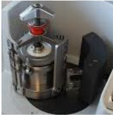
Şekil 2.23. Tek kavanozlu gezegensel bilyeli öğütücü.
