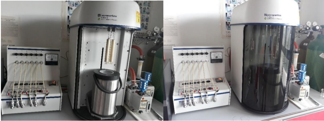
Şekil 3.6. BET cihazı açık ve kapalı iken.
