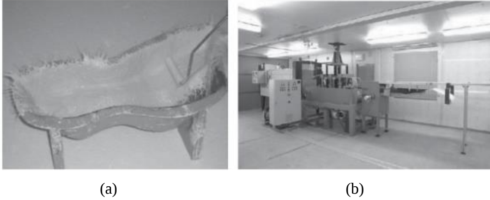
Şekil 3.5. TRC bileşenlerinin üretimi: a) el ile yerleştirme, b) mekanize işlemlerle yerleştirme (Brameshuber, W ve ark.,2006)
