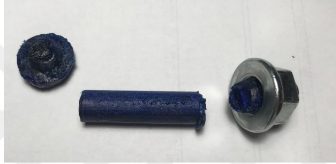
Şekil 4.9 835N yük altında kırılan eksen pimi
