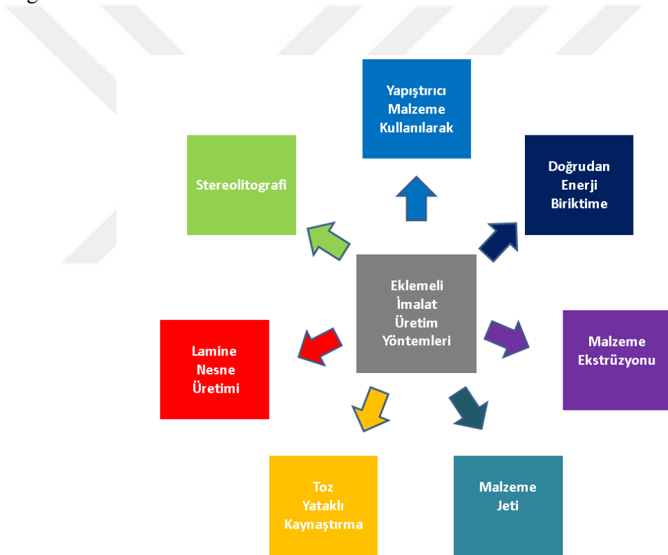
Şekil 2.2 ASTM’ ye göre eklemeli imalat sınıflandırması. (Lee, An ve Chua, 2017’ den değiştirilerek alınmıştır.)
