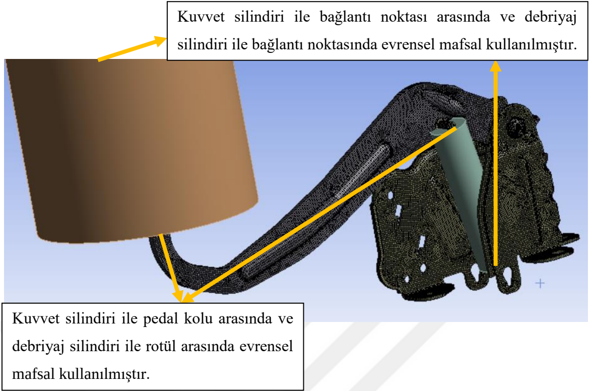
Şekil 3.33 Debriyaj pedalı için yapılan mafsalları tanımlamaları.
