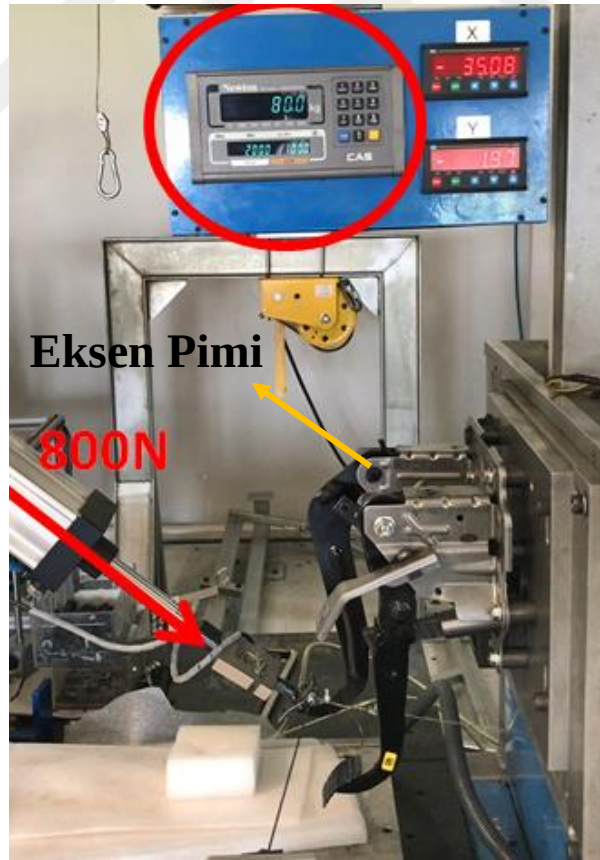
Şekil 4.7 800N yük altındaki debriyaj pedal kutusu
