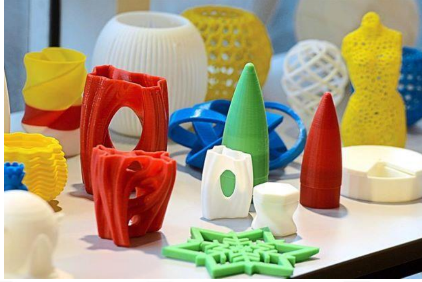
Şekil 2.11 Eriyik yığma modelleme tipi eklemeli imalat yöntemi ile üretilmiş örnek parçalar(Anonim 2021f’ den alınmıştır.)
