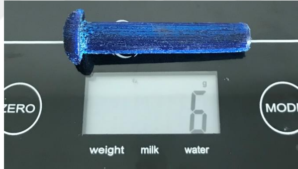
Şekil 4.15 PETG malzemeli eksen piminin hassas terazi ile ölçümü
