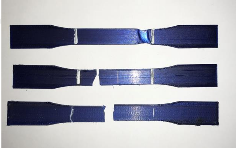
Şekil 4.6 Optimum parametre ve seviyeleri kullanılarak üretilen numunelerin çekme testi sonrası durumu
