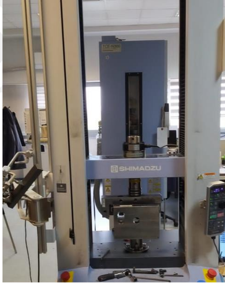
Şekil 3.20 Testlerde kullanılan 'Shimadzu Autograph AGS-X 50 kN' çekme cihazı.
