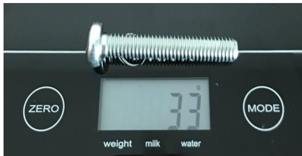
Şekil 4.16 Metal malzemeli eksen piminin hassas terazi ile ölçümü
