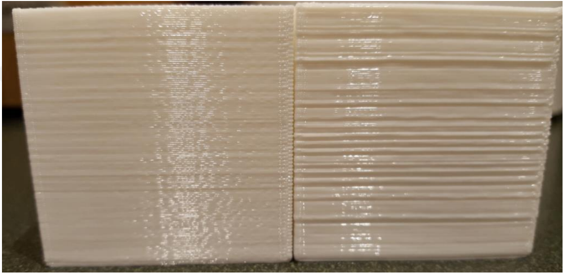
řekil 3.2 Z eksen d zensizliėinden kaynaklanan par a y zey p r zl l ė   rneėi(Anonim 2021k’ den alınmıřtır.)
