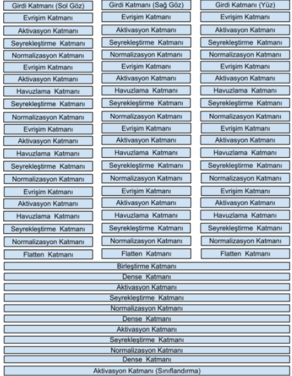
Şekil 4.4. Çalışma kapsamında yüz, sol göz, sağ göz özneliklerinin birleştirildiği fonksiyonel derin öğrenme modeli.
