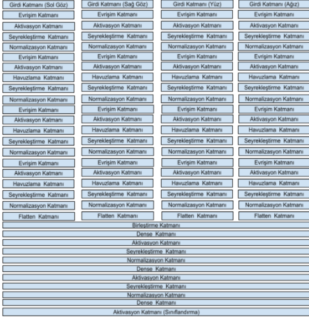
Şekil 4.5. Çalışma kapsamında yüz, sol göz, sağ göz ve ağız öz niteliklerinin birleştirildiği fonksiyonel derin öğrenme modeli.
