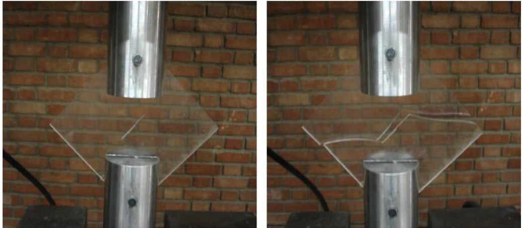
Şekil 4.2. Deney düzeneği ve akrilik malzemenin kırılma formu (Ayatollahi and Aliha, 2009)
