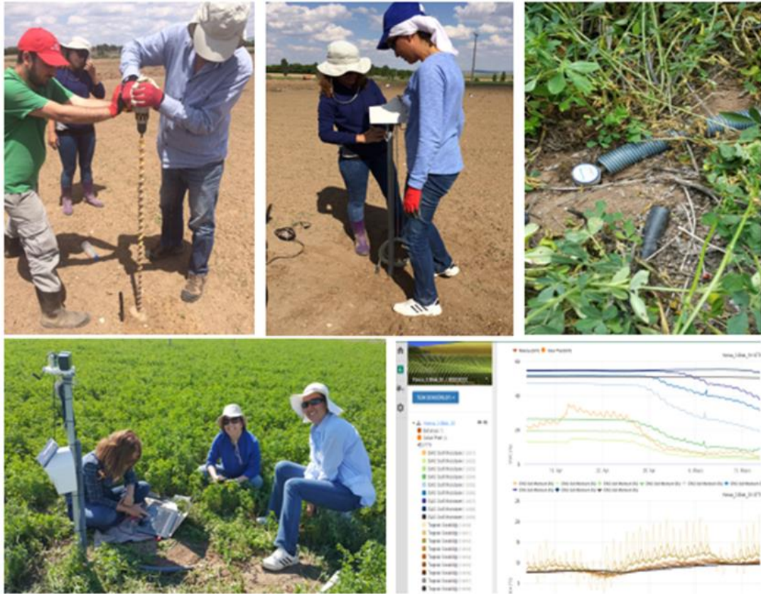
Şekil 3.5 Nem sensörlerinin kurulumu
