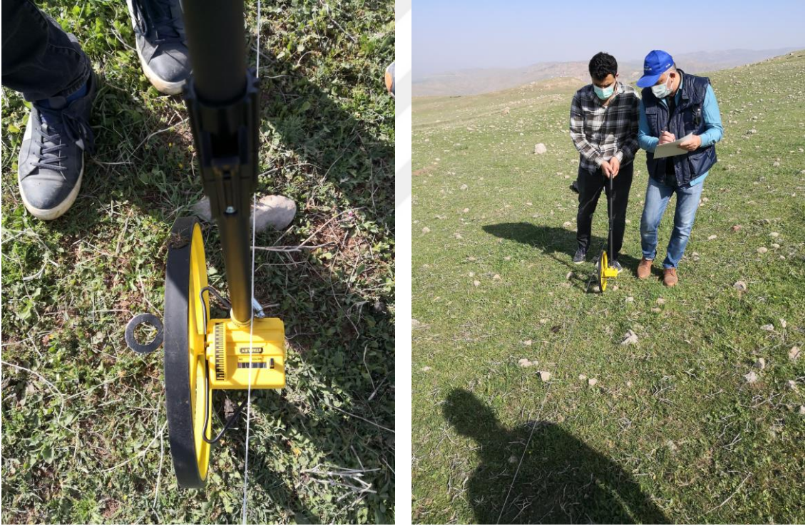
Şekil 3.4. Tekerlekli Lup (Halka) Yöntemi ile ölçüm
