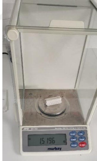
Şekil 4.10. 10.000'de 1 hassasiyet ölçüm yapan tartı ile belirlenen birim hacim ağırlık hesaplamaları
