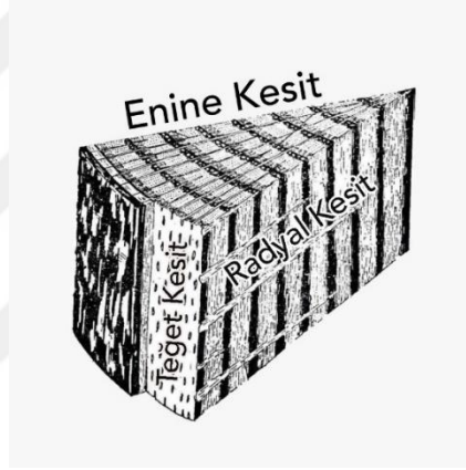
Şekil 3.12. Ahşabın lif yönleri (Anonim 1,2021)
