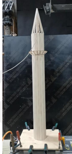
Şekil 3.25. Çalışmaya konu minare maketleri a) çapraz model, b) kabuk model
