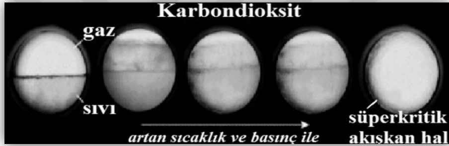
Şekil 1.5. Artan sıcaklık ve basınç ile CO 2 'in süperkritik akışkan hale geçişinin şematik gösterimi
