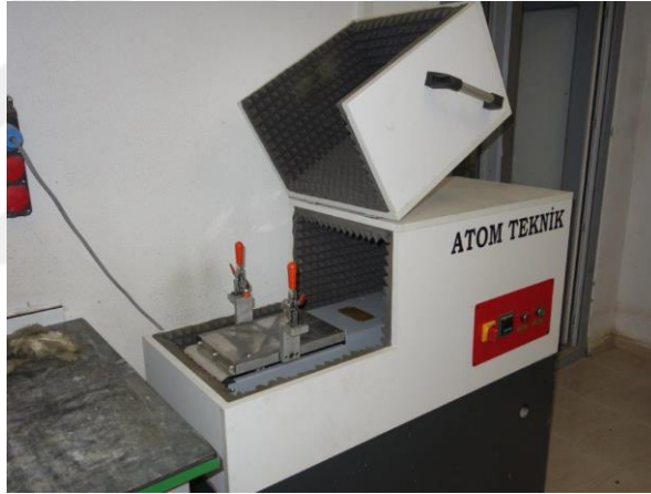
Şekil 10. Sarsma Cihazı (Şok Tablası)
