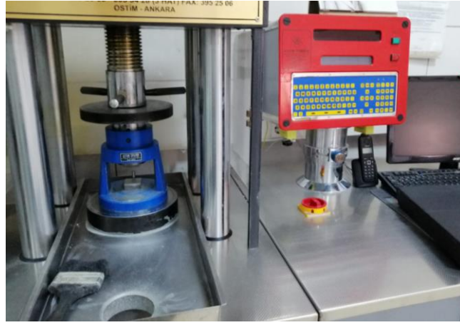
Şekil 11. Basınç Dayanım Cihazı
