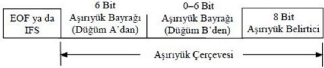
Şekil 4 CAN haberleşmesi aşırı yük çerçevesi (URL-1)
