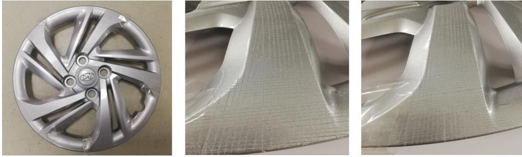
Şekil 3.48 Su dayanımı sonrası jant kapağı görseli ve adhezyon testi sonucu
