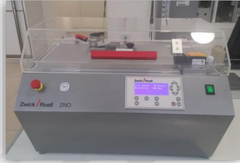
Şekil 2.27 Izod&Charpy darbe testi cihazı & Çentik açma cihazı
