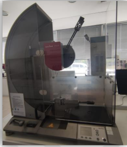
Şekil 2.27 Izod&Charpy darbe testi cihazı & Çentik açma cihazı
