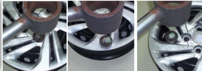
Şekil 3.46 Düşük sıcaklıkta bekletilen jant kapağı ağırlık düşürme darbe testi
