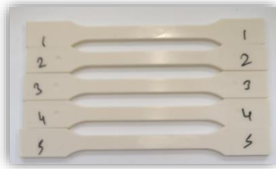
Şekil 3.2 Çekme testi 1A tipi test çubukları
