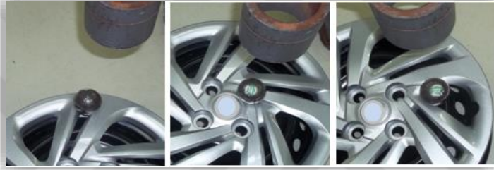
Şekil 3.45 Yükseklik sıcaklıkta bekletilen jant kapağı ağırlık düşürme darbe testi
