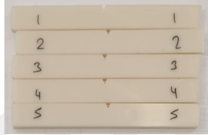
Şekil 3.11 İzod Çentikli Darbe Test Çubukları
