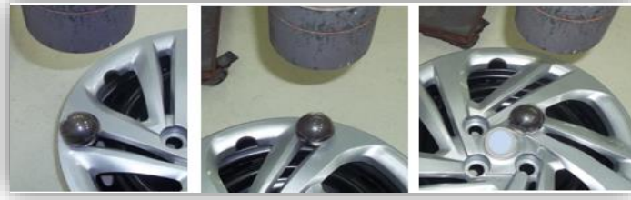
Şekil 3.47 Oda sıcaklığında jant kapağı ağırlık düşürme darbe
