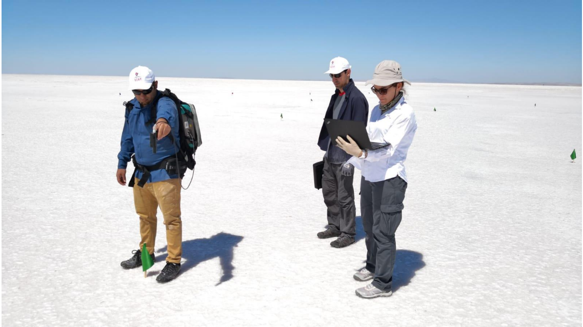
Şekil 2.11. ASD FieldSpec 3'ün arazide kullanımını gösteren bir kare
