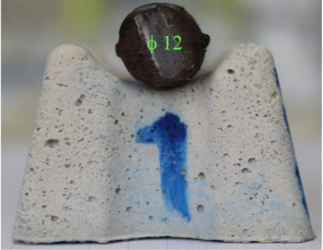
Şekil 2.4. Beton paspayına donatı yerleşimi.
