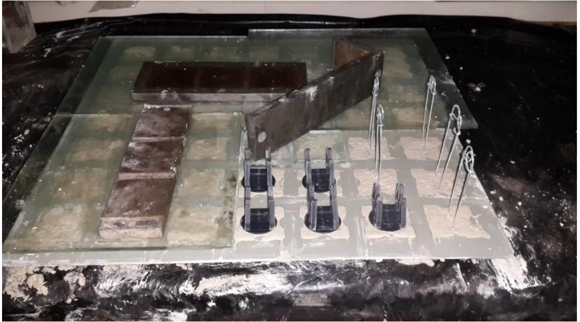
Şekil 2.2. Paspayı kalıbına numune dökümü.
