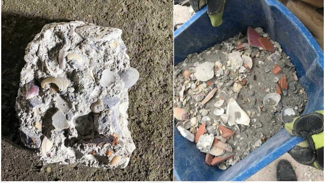
Şekil 1.8: Yeşilyurt Apartmanına ait beton parçası ve yıkıntıdan çıkan deniz kabukları [14].
