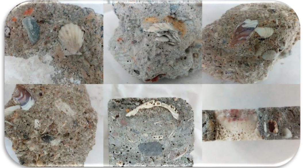
Şekil 4.3: Yıkıntılardan alınan beton numuneler
