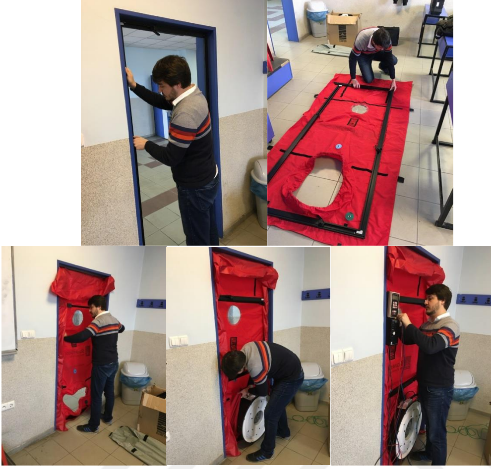
Şekil 4.25. Blower Door Test Ünitesi Kurulum Aşamaları
