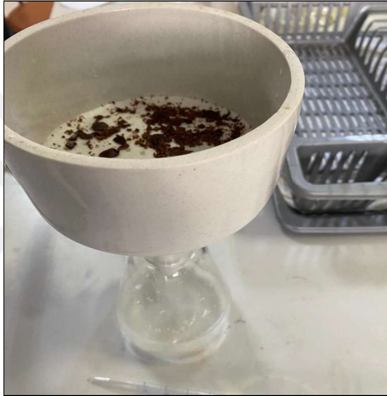
Şekil 6.4: Yıkama işlemi yapılan numune.
