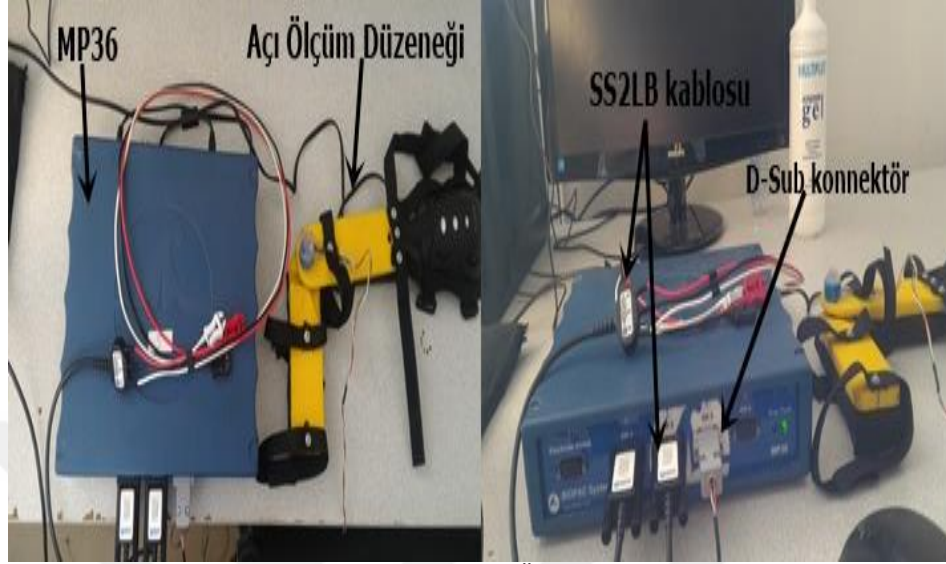
Şekil 3.12. MP 36 Veri Toplama Seti ve Açı Ölçüm Düzenegi
