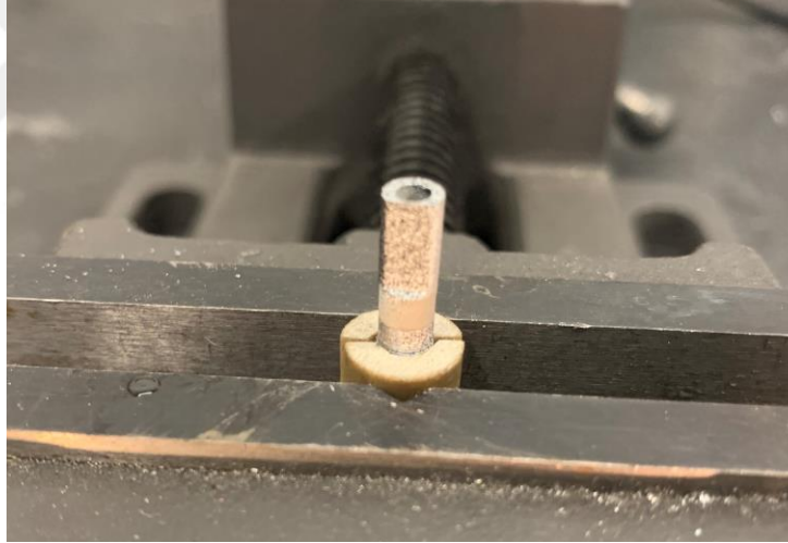
Şekil 2.2. İmplant-tarama gövdesi birleşiminin, polimer kılıflar kullanılarak kameraların bulunduğu masaya tutturulmuş görüntüsü.
