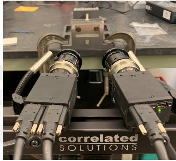
Şekil 2.5. Görüntü Korelasyon Sistemi (DIC) ile ölçümlerin yapılması.
