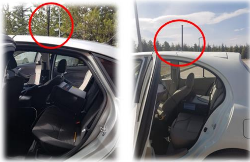
řekil 3.2 Aralar zerindeki anten yerleřimi. Araların iindeki ekipmanlar grlmektedir.
