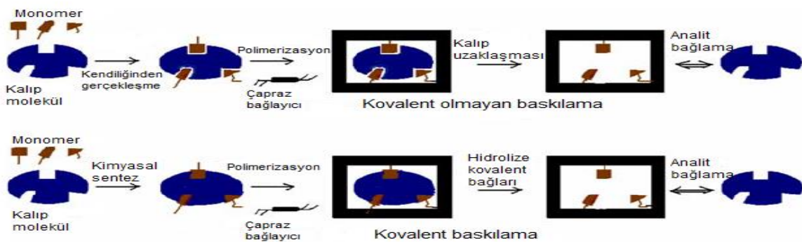
Şekil 2.2. Kovalent olmayan ve kovalent baskılama yöntemlerinin şematik görüntüsü (Wulff, Sharhan ve Zabrocki, 1973; Wulff ve ark., 1977).
